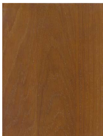
Slika 15: Kontrolni vzorec iz furnirane iverne plošče obdelan z lužilom in poliuretanskim lakom
