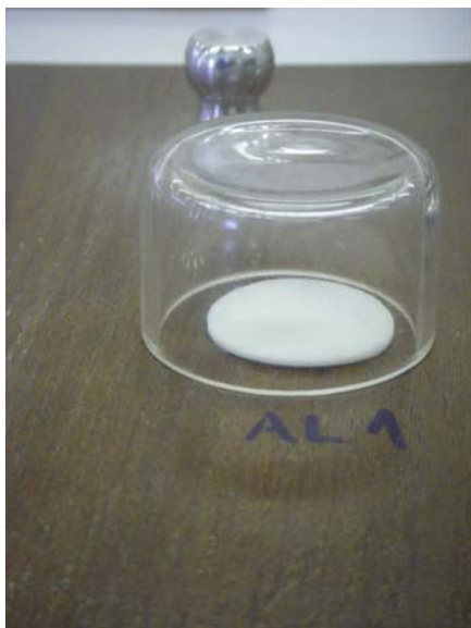
Slika 41: Tampon prepojen z preskusno tekočino na površini vzorca
