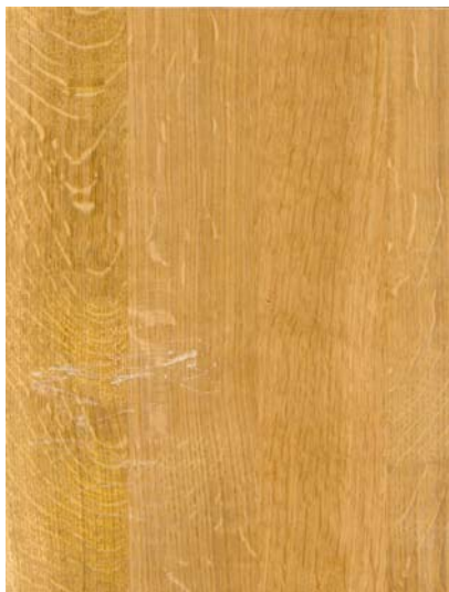
Slika 12: Kontrolni vzorec iz masivnega lesa obdelan s poliuretanskim lakom
