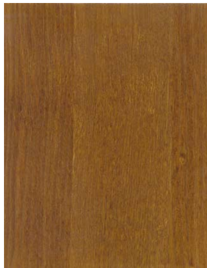
Slika 13: Kontrolni vzorec iz masivnega lesa obdelan z lužilom in poliuretanskim lakom
