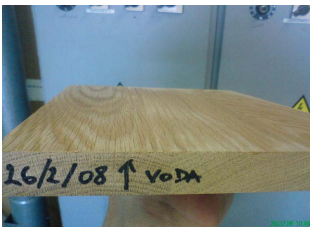
Slika 17: Lesna vlakna na površini po premazovanju z vodo
