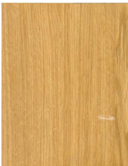
Slika 14: Kontrolni vzorec iz furnirane iverne plošče obdelan s poliuretanskim lakom
