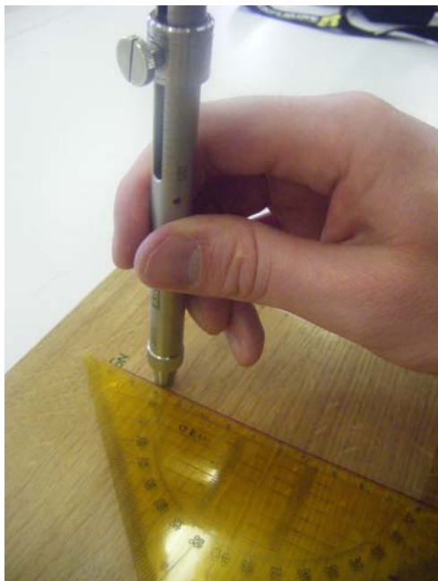
Slika 42: Razenje z vzmetnim svinčnikom po površini vzorca
