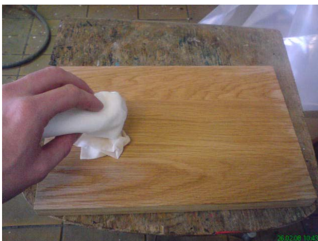
Slika 16: Mazanje surovih vzorcev z vodo
