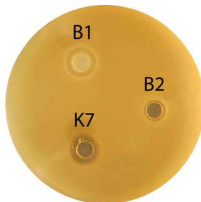
Slika 13: Protimikrobna aktivnost zbrane frakcije po selektivni SPE-eluciji supernatanta mleka, fermentiranega v bioreaktorju z L. helveticus BGRA43, s koncentracijo peptidov 13,80 mg/ml (B1) in 1,53 mg/ml (B2) in supernatanta seva K7 kot kontrola; indikatorski sev L. sakei NCDO 2714
