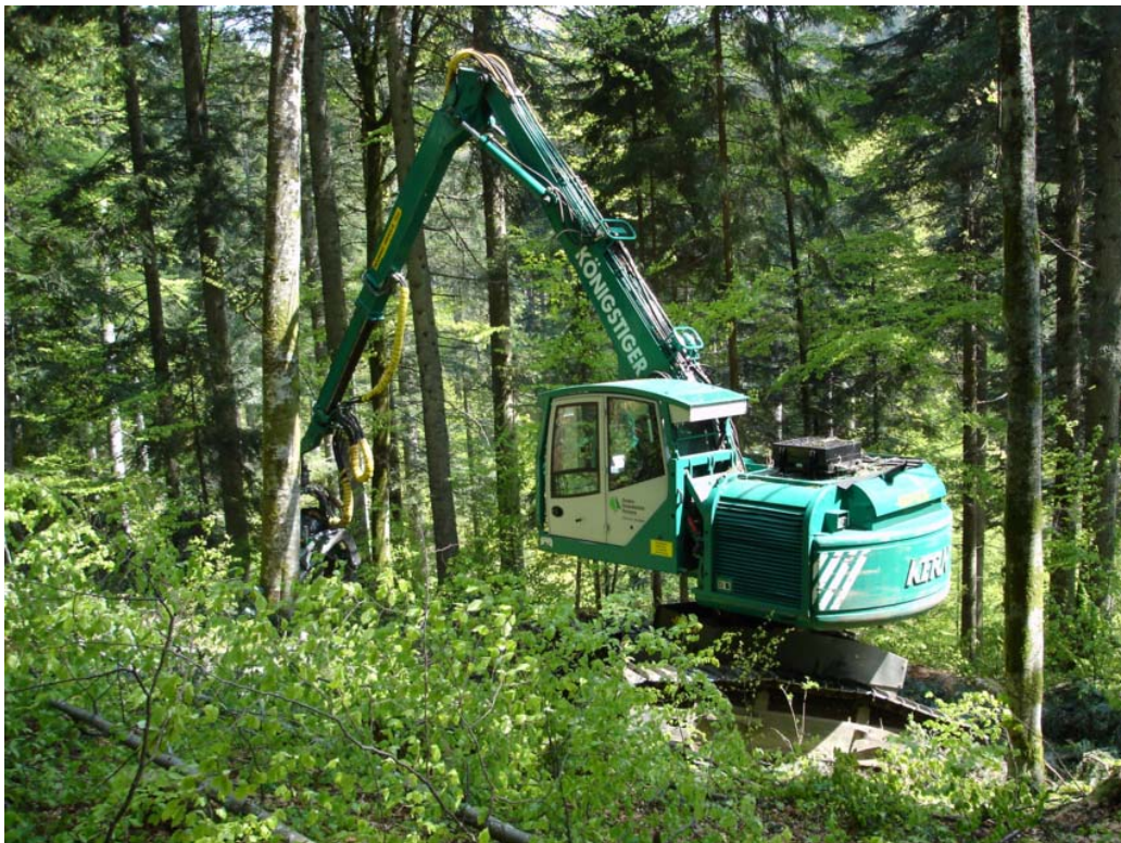
Slika 3: Stroj za sečnjo Impex Königstiger pri podiranju drevesa (foto: B. Košir)
