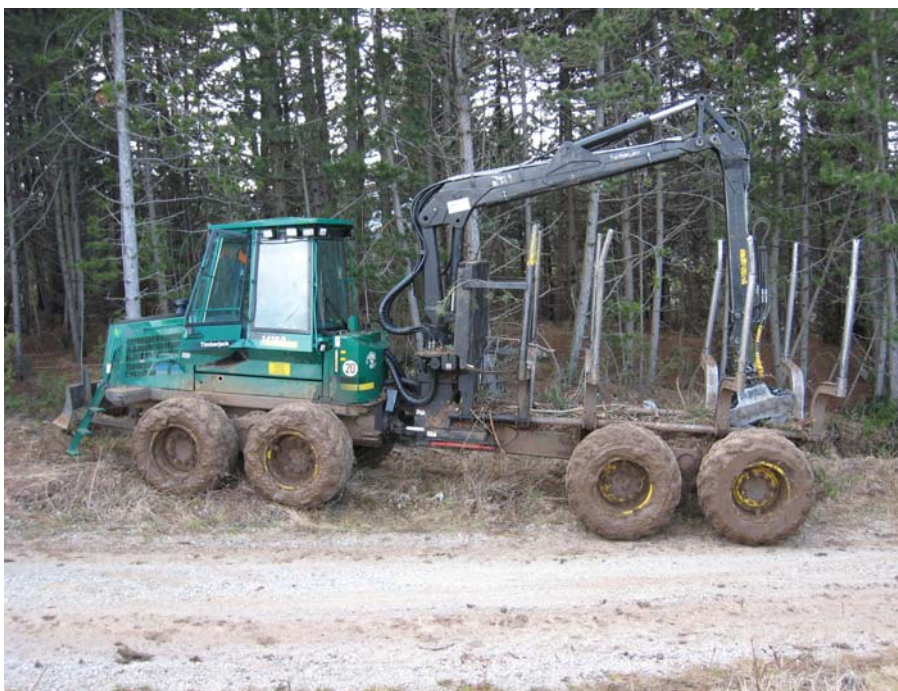
Slika 4: Zgibni polprikoličar Timberjack 1410D (foto: L. Biščak)
