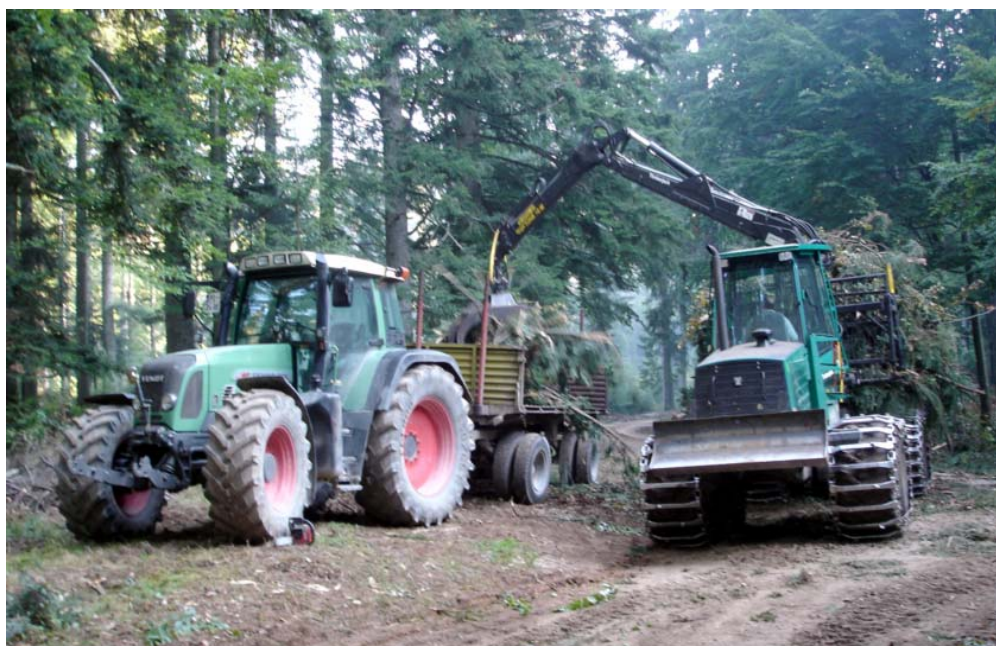
Slika 12: Prekladanje sečnih ostankov na traktorsko prikolico (foto: B. Košir)
