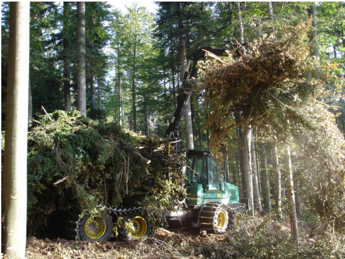
Slika 10: Nakladanje sečnih ostankov na zgibni polprikoličar (foto: B. Košir)
