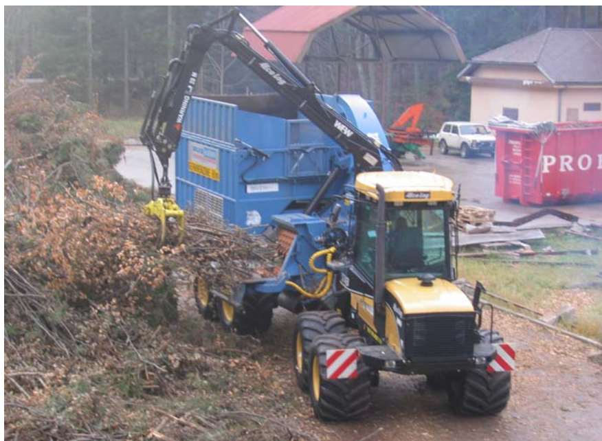
Slika 14: Sekalnik Bruks 801 C na Ecolog 574 B pri sekanju sečnih ostankov (foto: L. Biščak)
