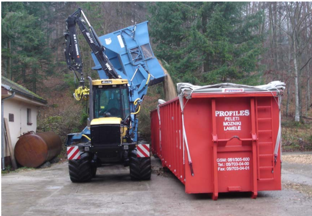
Slika 17: Sekalnik pri razkladanju sekancev v kontejner (foto: B. Košir)
