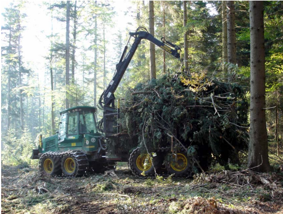
Slika 11: Zgibni polprikoličar natovorjen s sečnimi ostanki na poti k skladišču ob kamionski cesti (foto: B. Košir)
