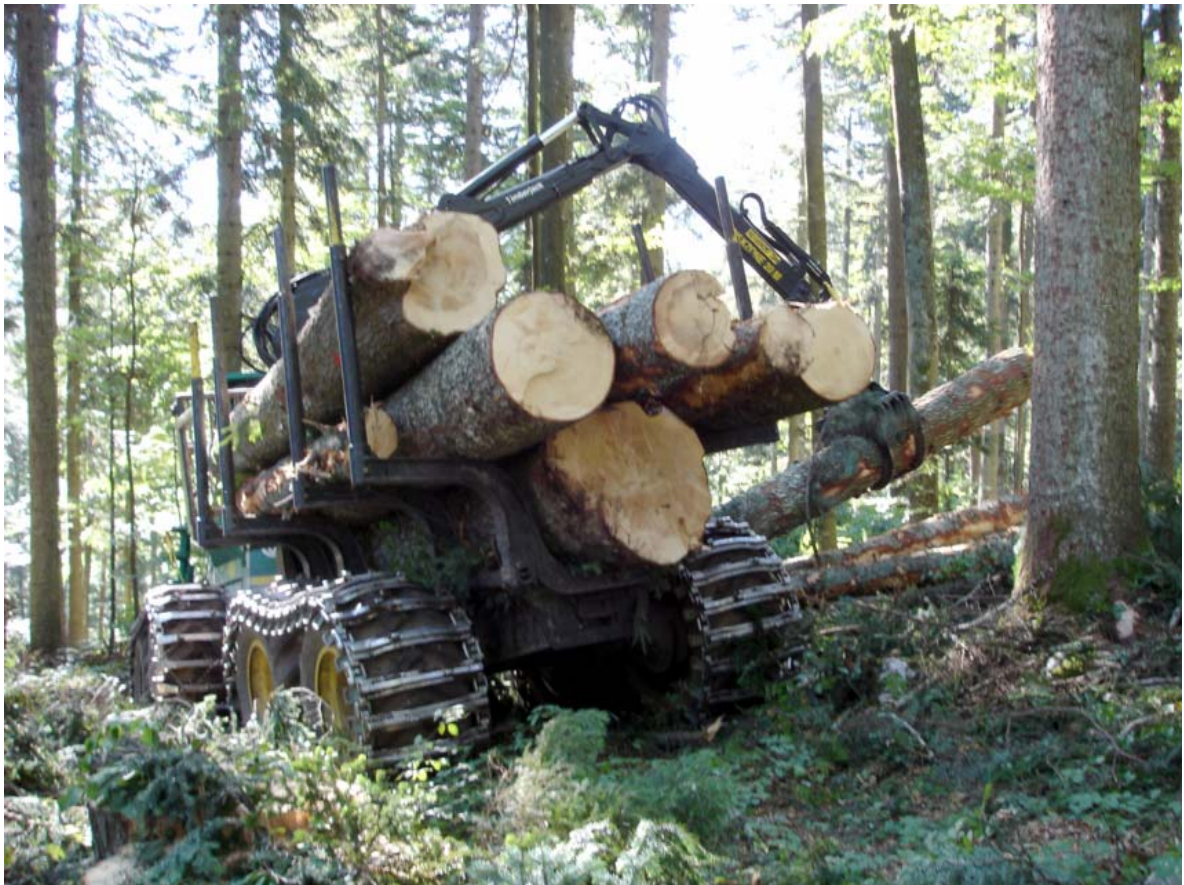
Slika 9: Nakladanje okroglega lesa na zgibni polprikoličar Timberjack 1410 (foto: B. Košir)
