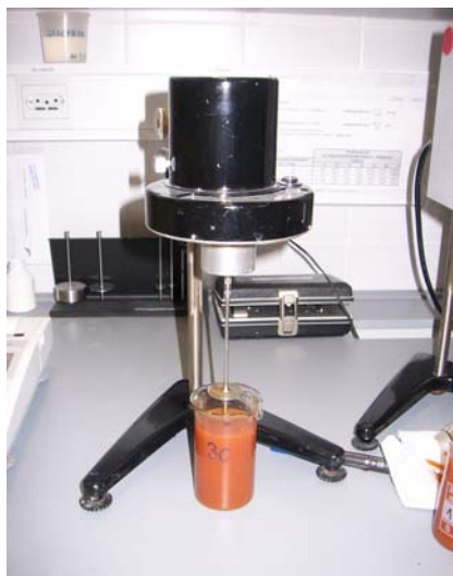
Slika 21: Merjenje "navidezne" viskoznosti z rotacijskim viskozimetrom Brookfield
