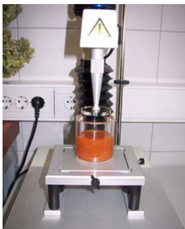
Slika 22: Merjenje teksturnih parametrov z aparaturom Texture Analyzer TA.XT Plus
