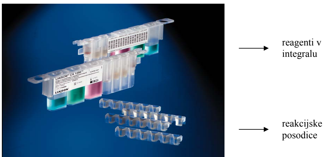
Slika 14: Komerčni reagentni integrali in reakcijske posodice (DiaSorin-Navodila za aparaturo LIAISON, 2002)
