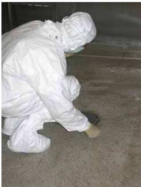
Slika 17: Vzorčenje površine tal pri vhodu v aseptični prostor (vzorčno mesto 12)
