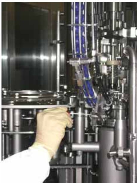
Slika 15: Vzorčenje površine vertikalnega tekočega traku po katerem pokrovčki v aseptičnem prostoru potujejo do zapiralca plastenk (vzorčno mesto 3)
