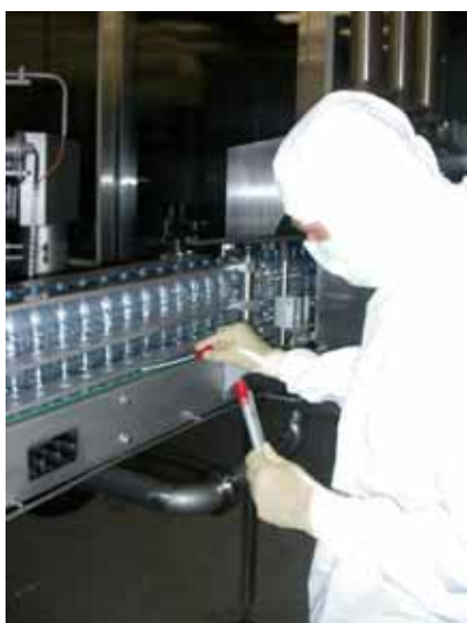
Slika 13: Vzorčenje površine vhodnega tekočega traku v aseptičnem prostoru (vzorčno mesto 1)
