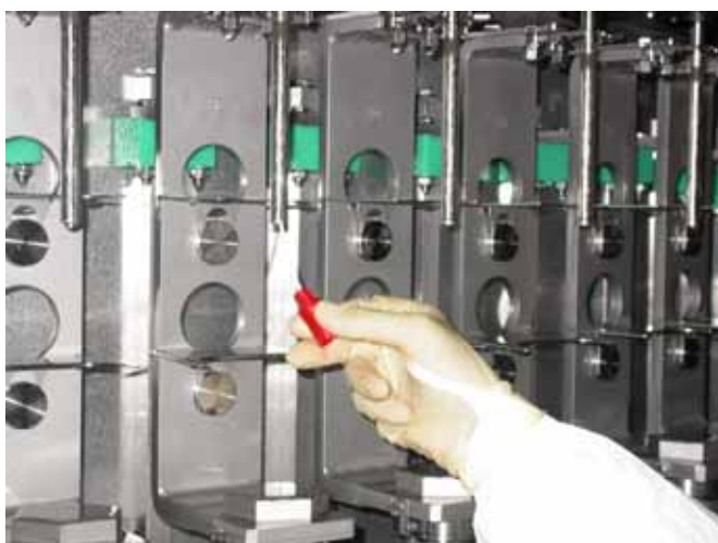
Slika 16: Vzorčenje notranje površine ene izmed polnilnih igel v aseptičnem prostoru (vzorčno mesto 10)
