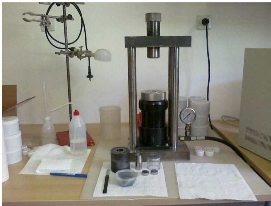
Slika 18: Hidravlična stiskalnica in pribor za izdelavo tabletk
