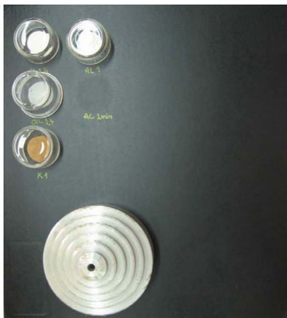
Slika 24: Preizkušanje odpornosti premaznih sistemov.
