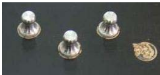
Slika 25: Določanje oprijemnosti z metodo odtrgovanja pečatov.
