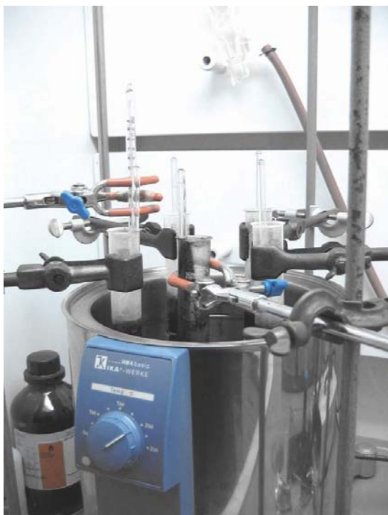
Slika 10: Utekočinjanje v tankostenskih epruvetah
