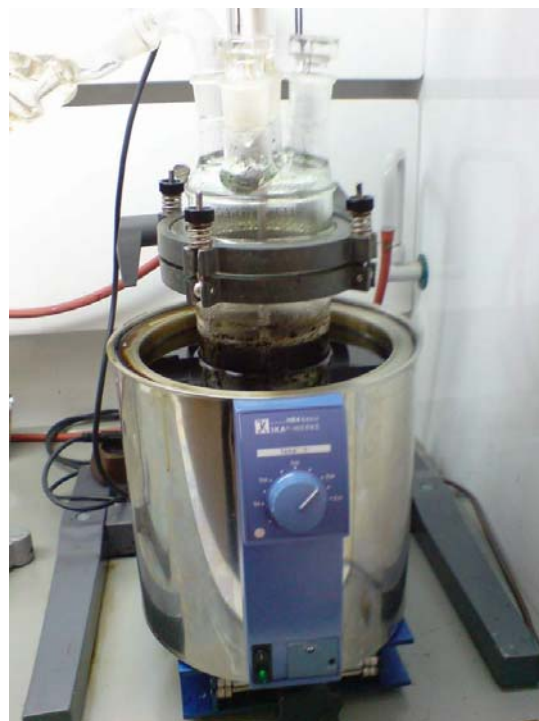
Slika 11: Utekočinjanje v reaktorski posodi.
