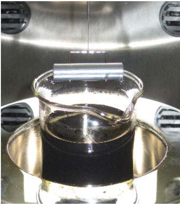
Slika 6: Merjenje gostote s tenziometrom.
