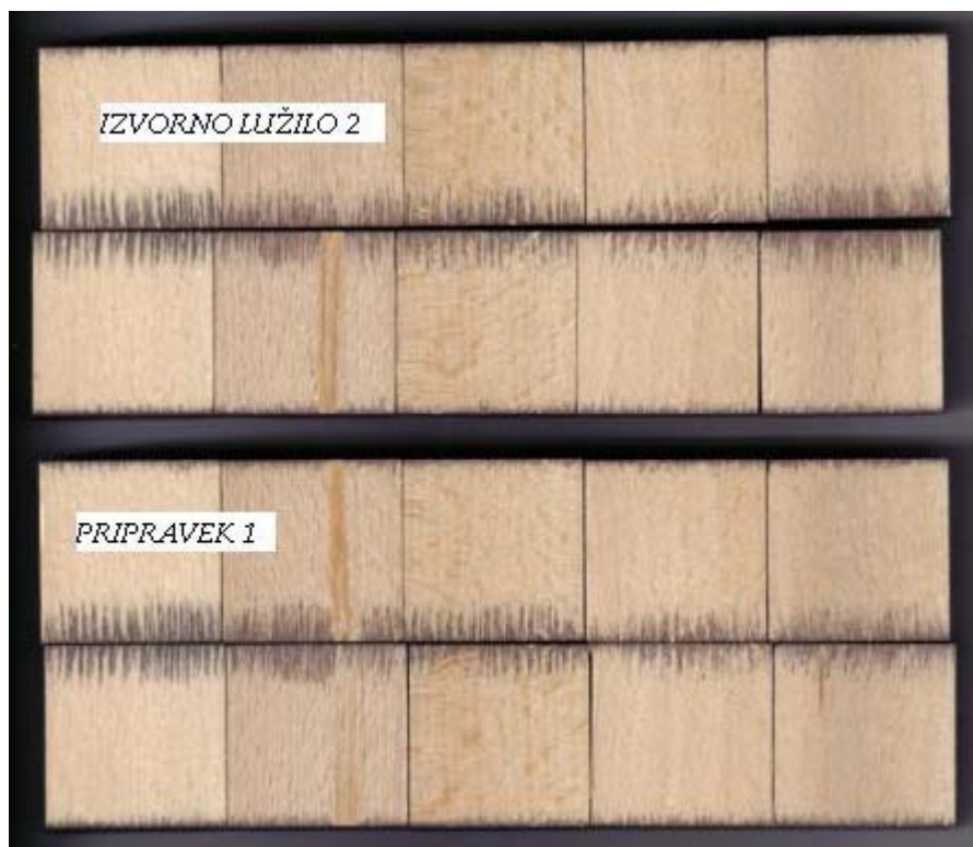
Slika 4: Globina penetracije izvornega lužila 2 (zgoraj) in pripravka 1 (spodaj).
