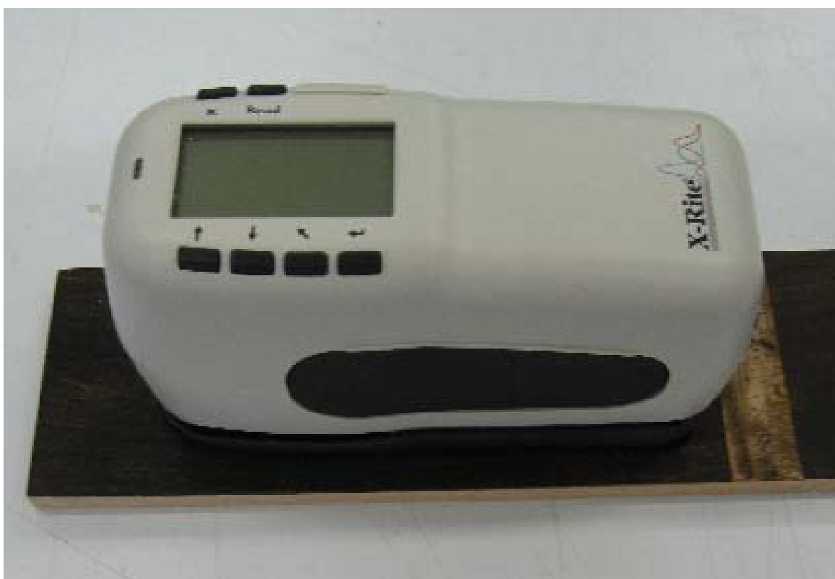
Slika 10: Merjenje barve s sferičnim kolorimetrom.
