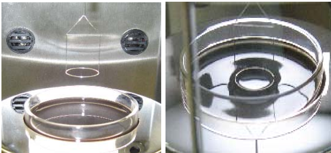
Slika 7: Merjenje površinske napetosti s tenziometrom, z metodo obročka (desna slika prikazuje položaj obročka med meritvijo).
