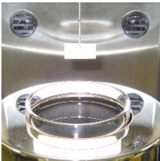
Slika 8: Merjenje površinske napetosti s tenziometrom, z metodo ploščice.
