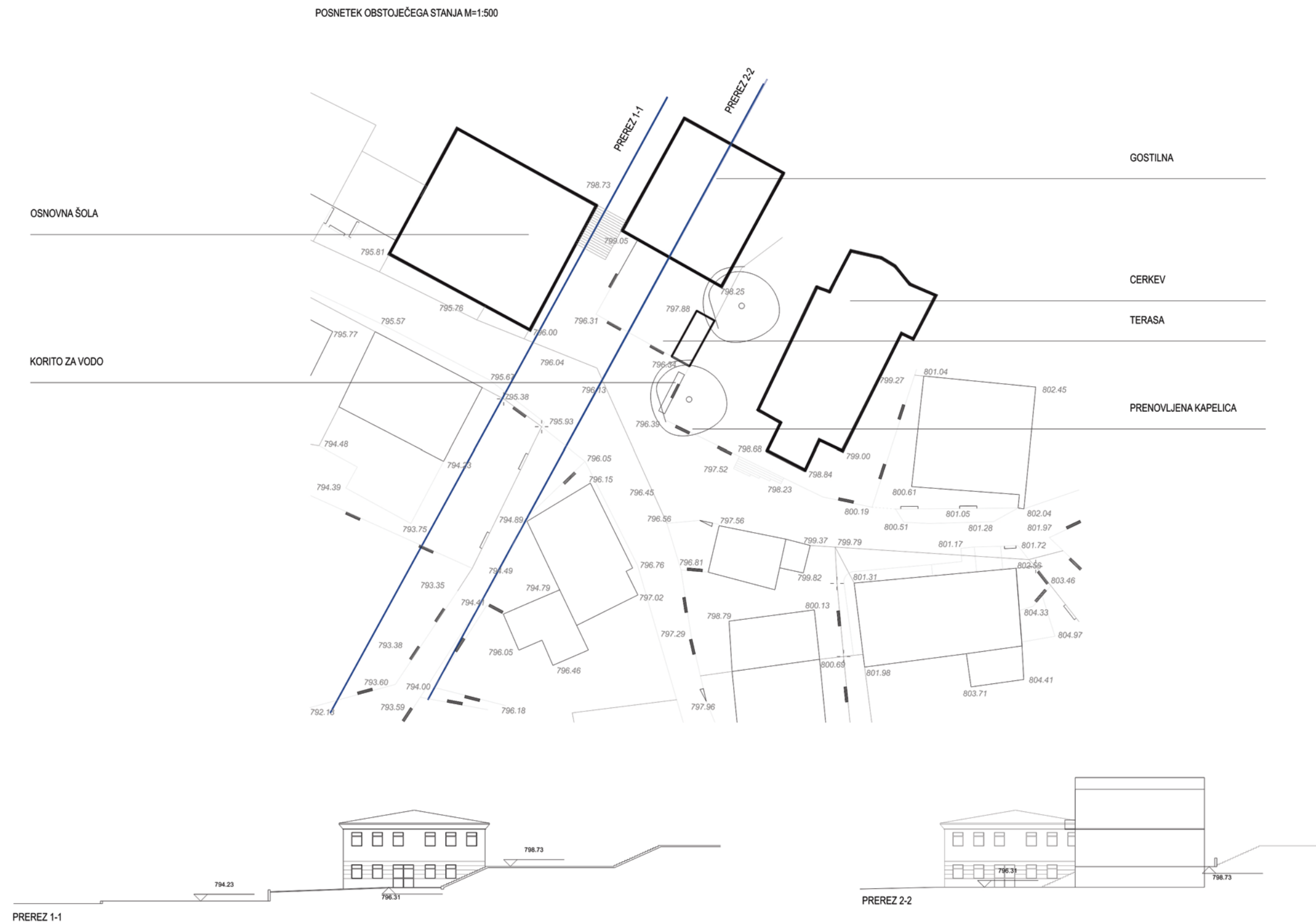
Slika 44: Posnetek obstoječega stanja 1:500
