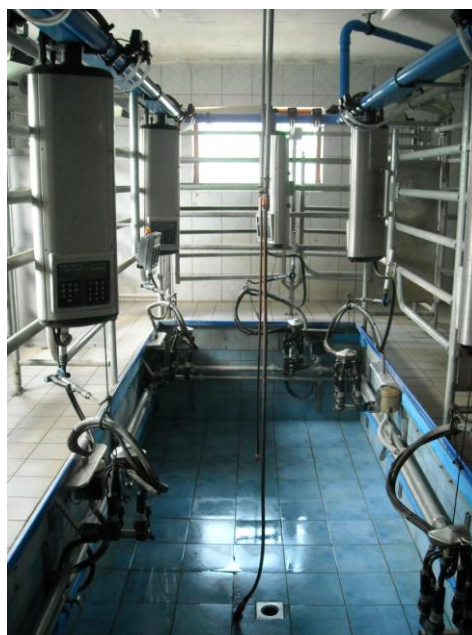
Slika 14: Molzišče avtotandem (foto: Marija Burjek)
