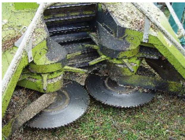
Slika št. 12: Žagalno ustje za lesnate rastline na silažnem kombajnu (FAO)
