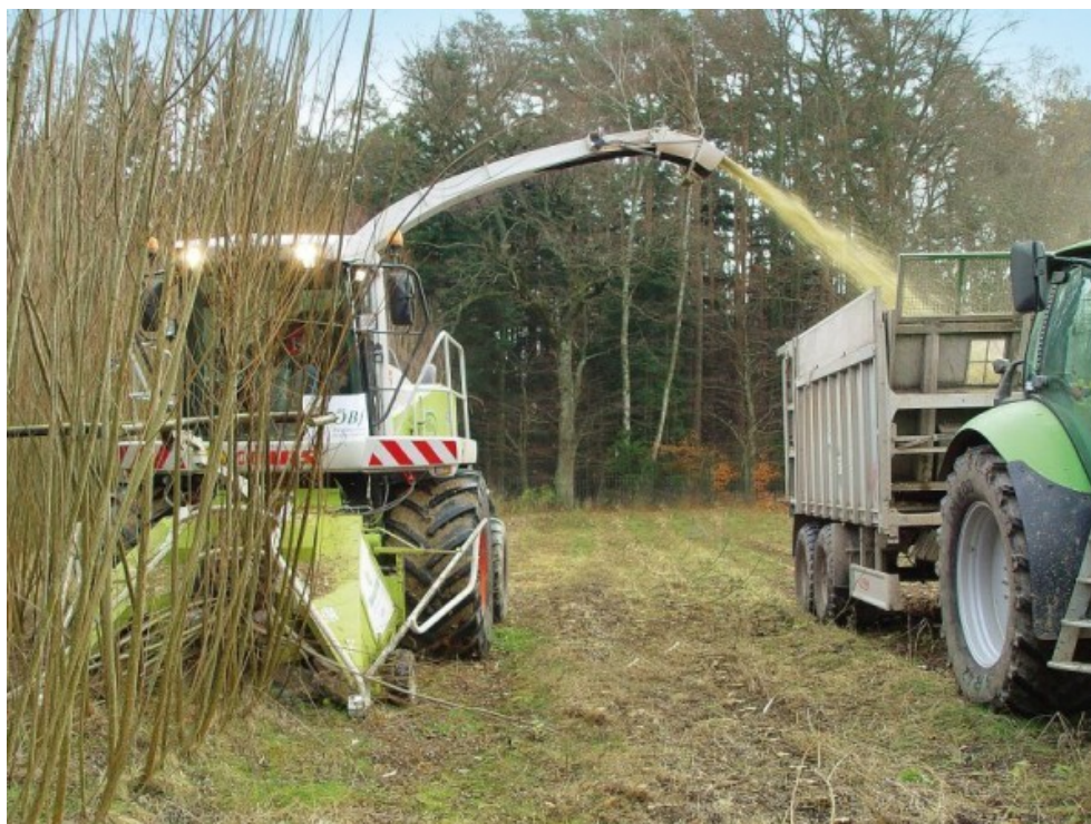
Slika št. 13: Sečnja in izdelava sekancev s prilagojenim samovoznim silažnim kombajnom z nameščenim žagalnim ustjem (Slovenski vremenarski blog, 2009)
