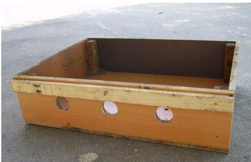
Slika 19: Zaboj – s sprednje strani so vidne izvrtane luknje, skozi katere smo vstavili merilne cevi.
