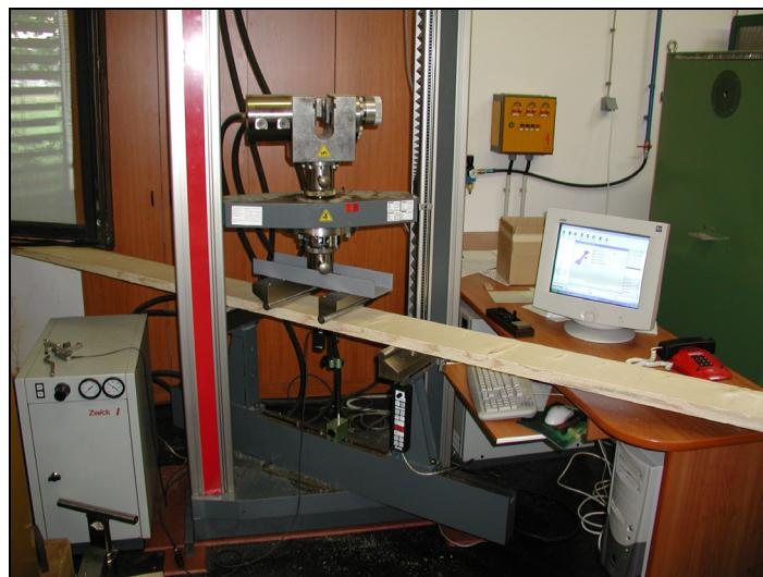
Slika 19: Princip izvajanja štiri-točkovnega upogibnega testa
