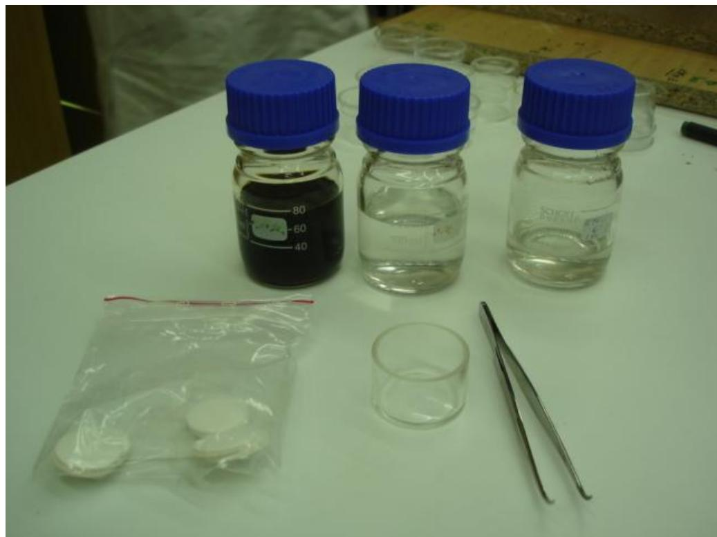
Slika 7: Pripomočki za določanje odpornosti površine proti hladnim tekočinam
