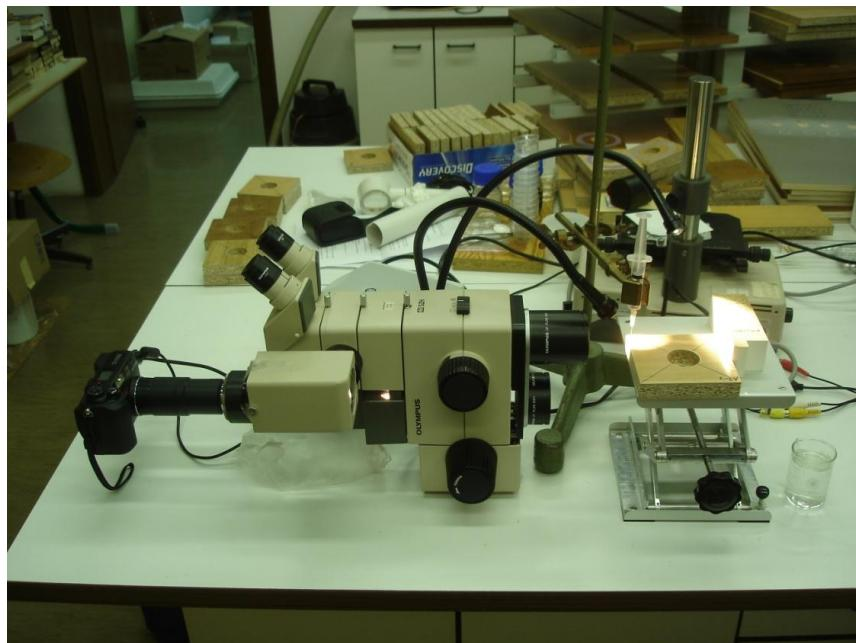
Slika 12: Stereomikroskop z računalniškim zajemom slike
