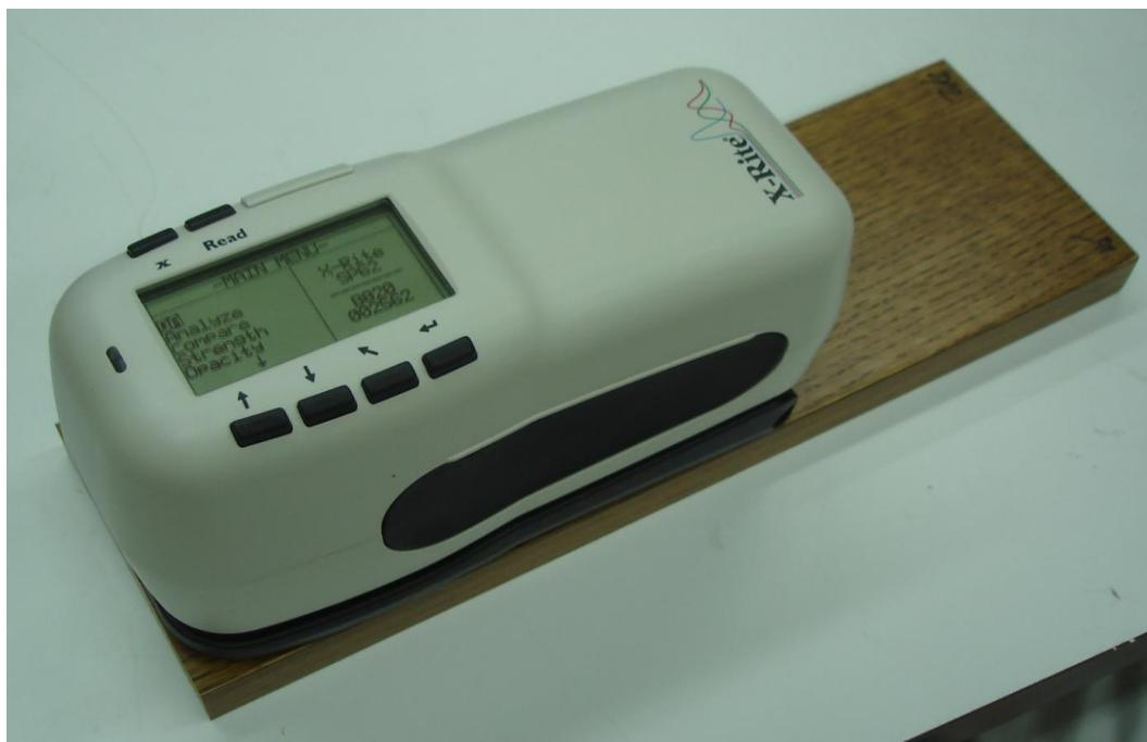
Slika 3: Spektrofotometer za merjenje barve
