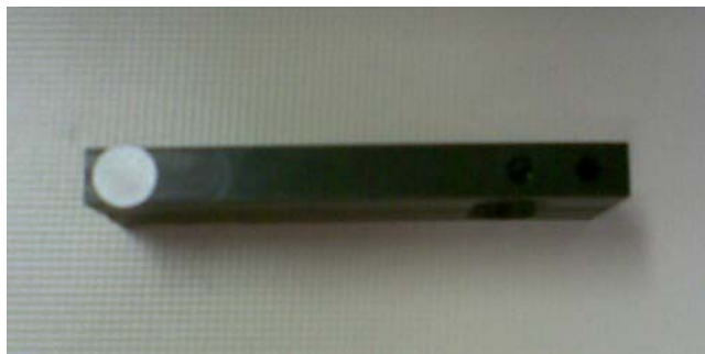
Slika 3: Plastični vložek za napravo Spectrum One
