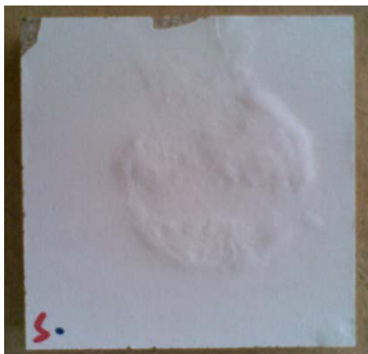
Slika 25: Preizkušanelec po končanem testu določanja odpornosti proti vodni pari (spodnja stran iverne plošče D)
