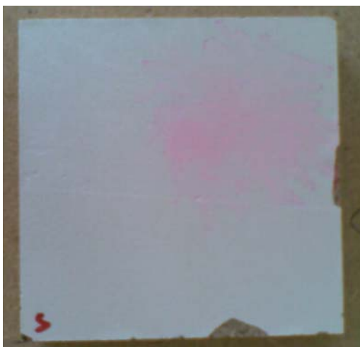
Slika 22: Premajhna otrdelost površine na spodnji strani iverne plošče D
