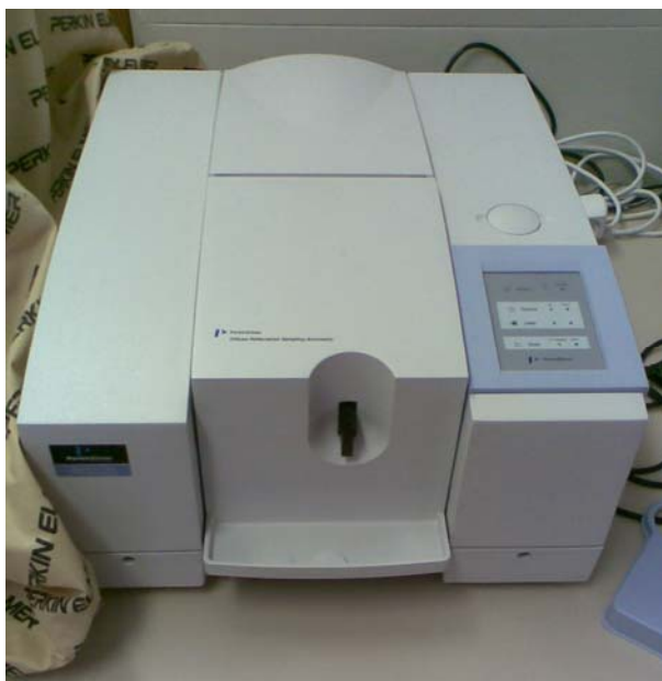
Slika 2: Instrument Spectrum One za merjenje nihajnih (FT-IR) spektrov
