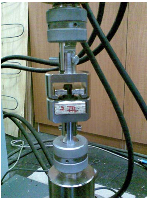
Slika 7: Preizkušanec vpet v trgalni stroj
