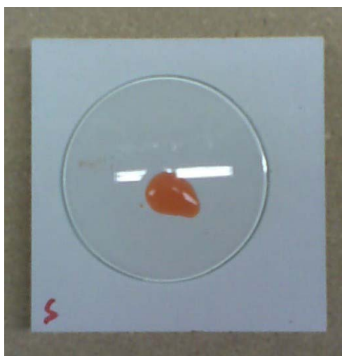
Slika 9: Testiranje vzorca na stopnjo otrdelosti površine
