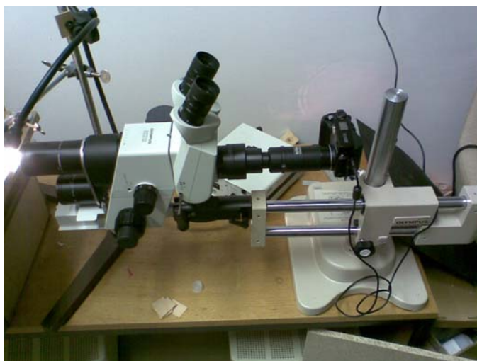
Slika 5: Laboratorijska oprema za merjenje kontaktnega kota
