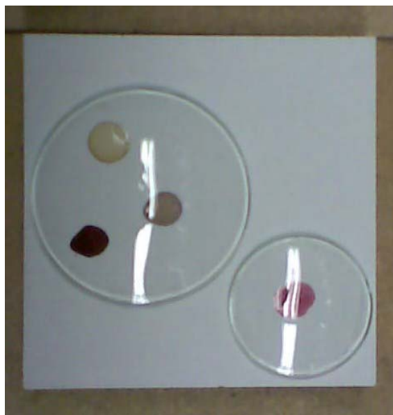
Slika 11: Testiranje vzorca na odpornosti proti substancam
