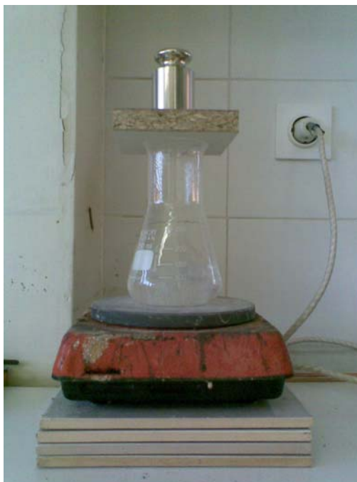
Slika 10: Testiranje vzorca na odpornost proti vodni pari
