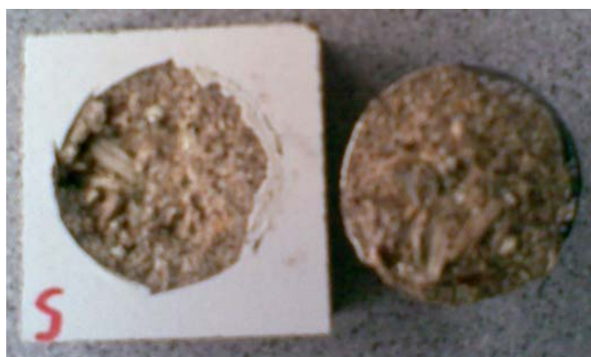
Slika 19: Zadosten spoj pri iverni plošči C
