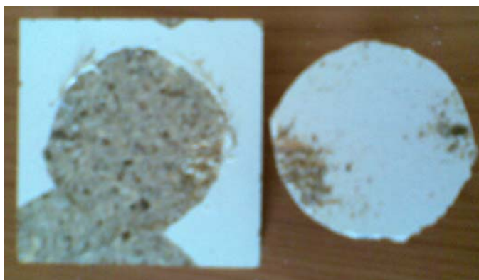
Slika 20: Nezdosten spoj pri iverni plošči D
