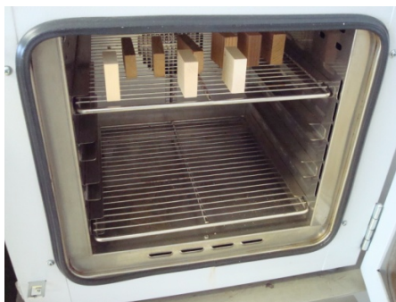
Slika 11: Sušenje vzorcev v sušilniku, Kambič, LT-80
