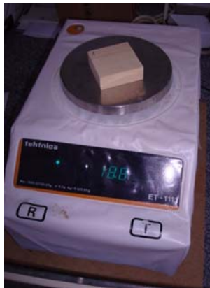
Slika 10: Tehtanje vzorcev na elektronski tehtnici, Tehtnica, ET-1111
