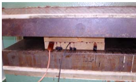
Slika 16: Stiskanje leplencev in spremljanje temperature ter dielektričnih lastnosti med lepljenjem
