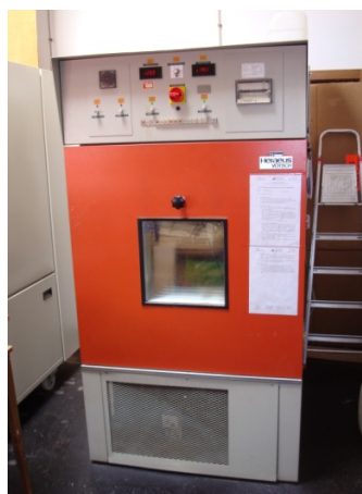
Slika 14: Klima komora, Heraeus Vötsch VTRK 500 MU
