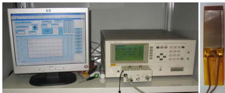
Slika 15: LCR meter, Agilent 4285A (levo) in IDEX senzor (desno)
