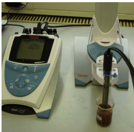
Slika 12: Merjenje vrednosti pH s pH metrom, Thermo Electron Corporation, Orion 3 Star
