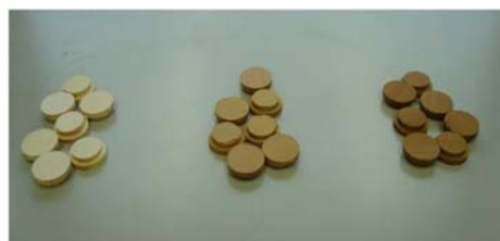
Slika 8: Preskušanci v obliki diskov za merjenje utrjenosti lepila z reometrom (levo skica, desno slika diskov)
