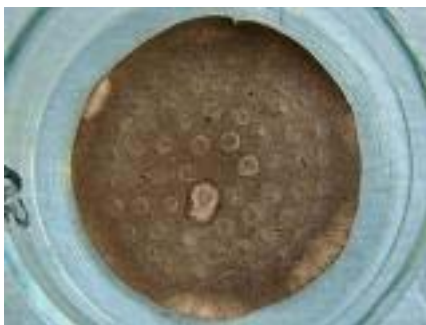
Slika 34: Ostanek po času reakcije 45 minut pri utekočinjenju s trimetilol propanom
