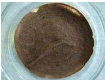
Slika 30: Ostanek po času reakcije 30 minut pri utekočinjenju z neopentil glikolom
