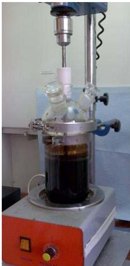
Slika 15: Sestavljena aparatura za utekočinjenje lesa (Foto: Matjaž Kunaver)
