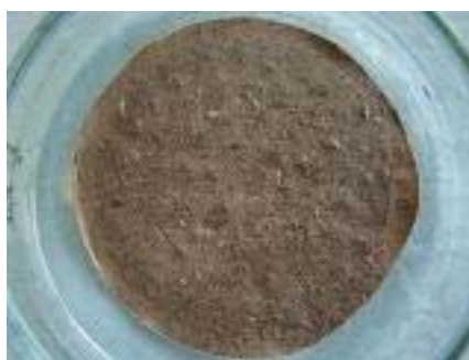
Slika 33: Ostanek po času reakcije 30 minut pri utekočinjenju s trimetilol propanom
