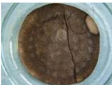
Slika 32: Ostanek po času reakcije 60 minut pri utekočinjenju z neopentil glikolom
