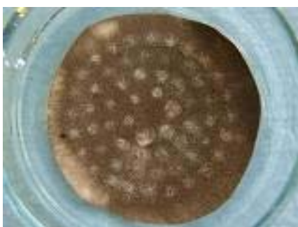
Slika 35: Ostanek po času reakcije 60 minut pri utekočinjenju s trimetilol propanom
