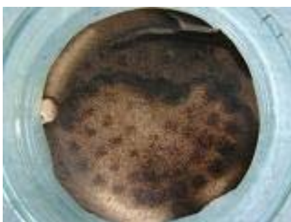
Slika 31: Ostanek po času reakcije 45 minut pri utekočinjenju z neopentil glikolom
