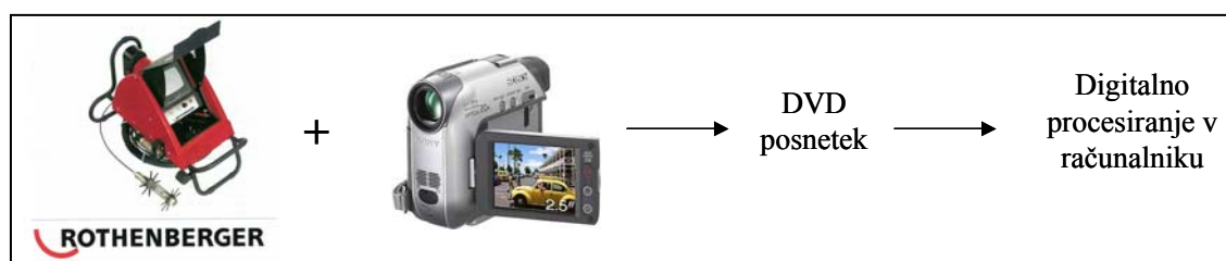
Slika 4: Ugotavljanje stanja detaljne drenaže z metodo inšpekcijske kamere (povzeto po Tlapakova in Kulhavy, 2006).
