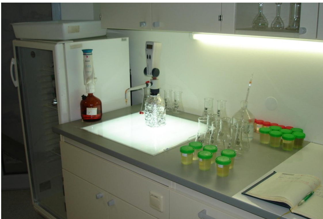
Slika 7: Titracijska metoda določanje prostega in skupnega žveplovega dioksida po Ripperjevi metodi
