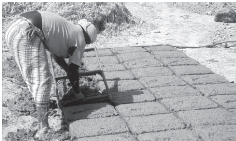
Slika 3 Postopek izdelovanja glinenih zidakov z lesenimi modeli (Zbašnik Senegačnik, 2005)
