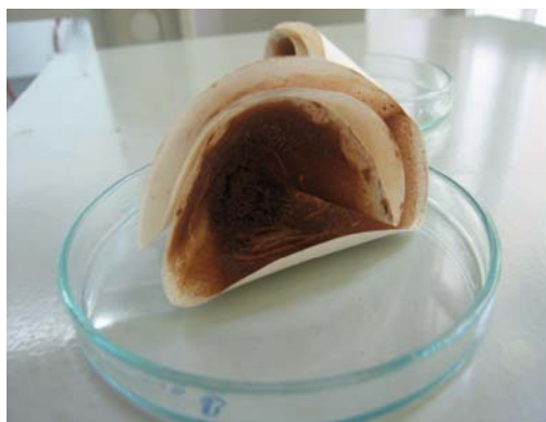
Slika 16: Kuhanje reakcijske zmesi v digestoriju (levo) ter lignin na filtrirnem papirju po izpiranju in sušenju (desno)
