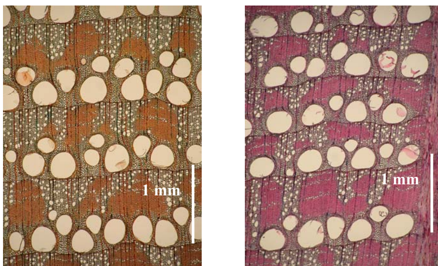
Slika 27: Prečni prerez hrastovine z ozkimi branikami iz deske Hrast 1 (foto: Zupančič)
