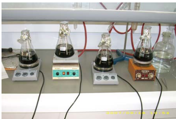
Slika 16: Kuhanje reakcijske zmesi v digestoriju (levo) ter lignin na filtrirnem papirju po izpiranju in sušenju (desno)
