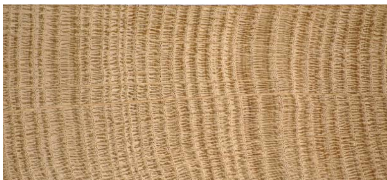
Slika 11: Prečni prerez hrastovine. Tudi s prostim očesom je v braniki mogoče razpoznati izmenjujoče plasti libriformskih vlaken (temni deli) in traheid s trahejami kasnega lesa (svetli deli).
