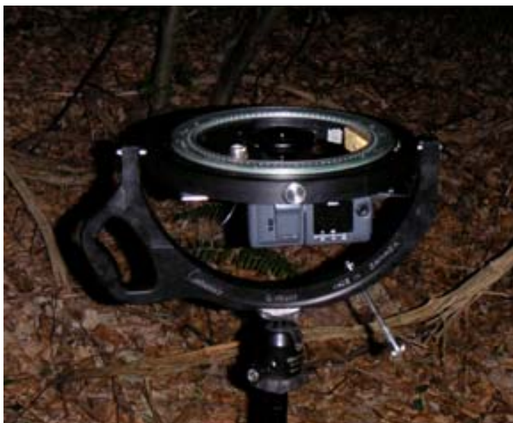
Slika 8: Digitalni fotoaparati z objektivom 'ribje oko' nameščena na samo-uravnavnem stojalu z avtomatskim iskalcem severa
