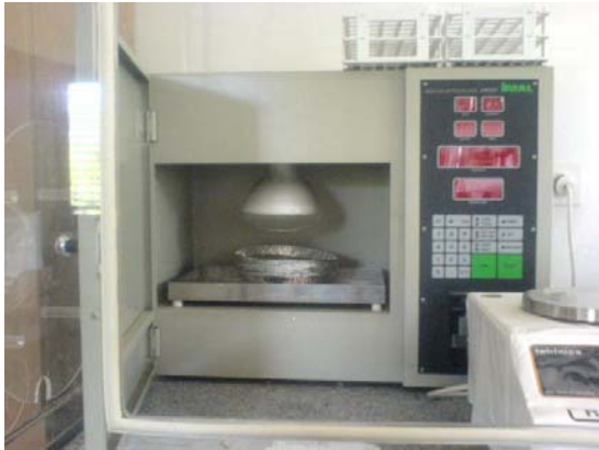
Slika 1: Naprava za merjenje vlažnosti iverja
