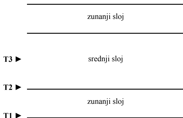
Slika 2: Razporeditev merilcev za merjenje temperature v plošči med stiskanjem
