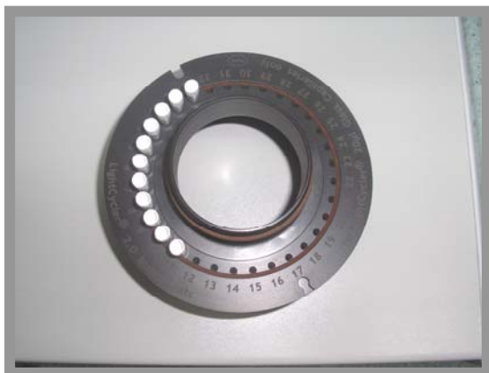
Slika 10: Rotor z vstavljenimi kampilarami (od zgoraj).
