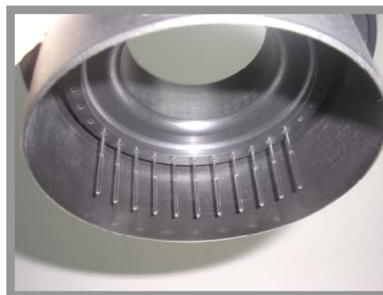
Slika 9: Rotor z vstavljenimi kampilarami (od spodaj).
