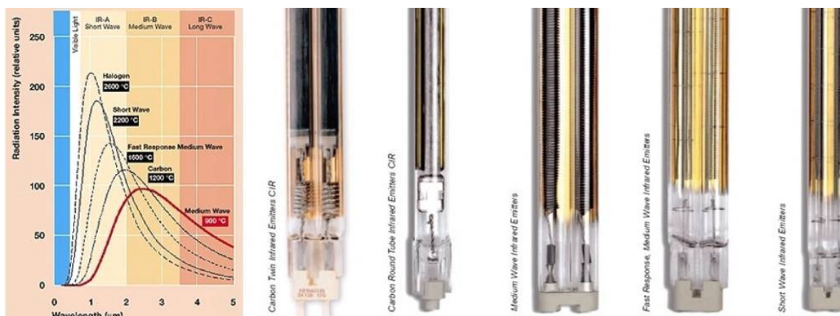
Slika 35: Emisijske temperature in dolžine različnih IR sevalnikov in slike različnih IR žarnic (Infrared modules ... , 2005 in. Medium wave ... , 2000).
