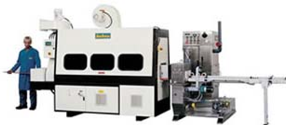
Slika 11: Podtlačna komora za oblivanje in UV sušilnik (UV Finishing ... , 2003).
