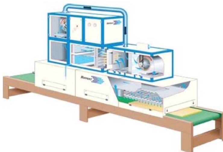
Slika 41: Shema delovanja adsorpcijskega sušilnika in slika adsorpcijske enote (Dry air, 2002).
