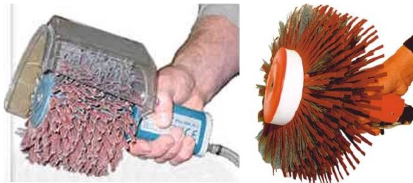
Slika 29: Fladder-jev in Qiuckwood-ov ročni brusilnik z brusilno krtačo (Manual machines ... , 2005 in 1-hand tool ... , 2003).
