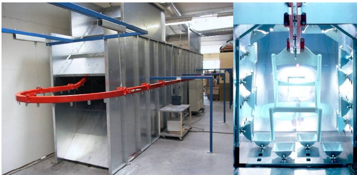
Slika 45: Prototip kanala za UV utrjevanje v inertni atmosferi (Beck in sod., 2003).
