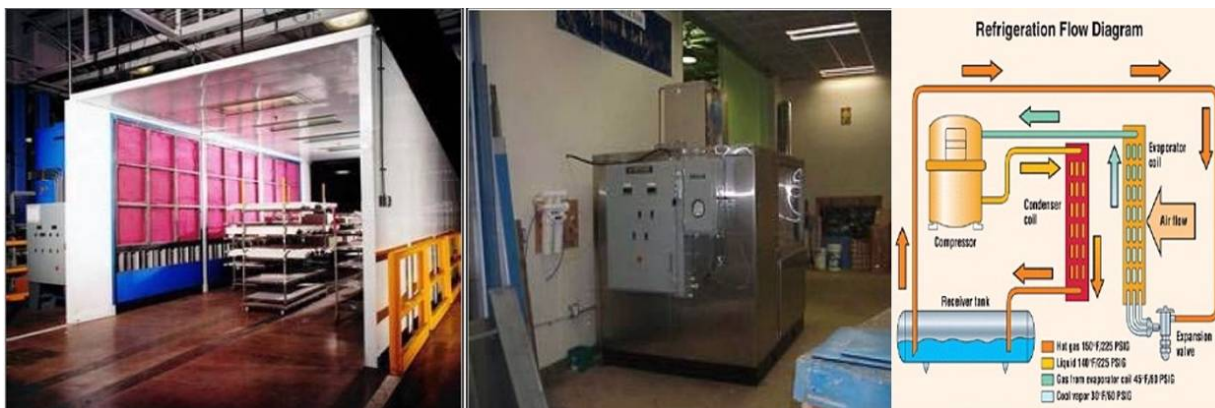
Slika 40: Kondenzacijski sušilni tunel, kondenzacijski agregat in shema delovanja (Rajasinghe, 1996).
