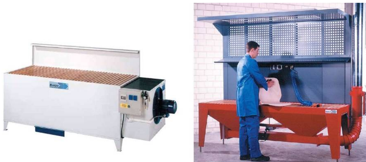
Slika 33: Brusilna miza s filtri in s priključkom na odsesovalni sistem (Grinding, 2006).
