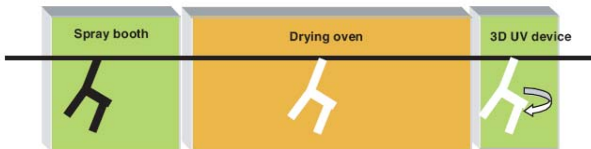
Slika 48: Potrebna oprema za utrjevanje vodnih UV lakov v inertni atmosferi z "Uvitec"-om. (Soljamo, 2006).
