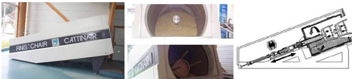
Slika 26: Stroj za avtomatizirano brušenje v bobnu (Model EPF ... , 2004).
