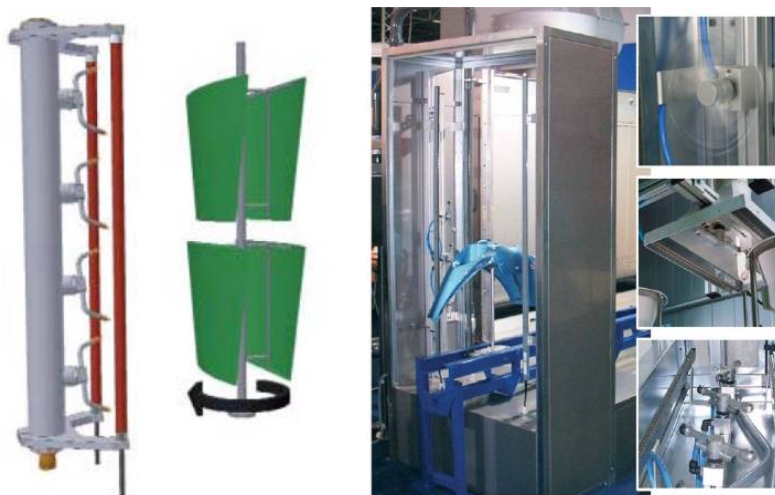
Slika 30: Ionizacijski napravi za čiščenje prostorskih izdelkov (Technical brochure ... , 2005 in Dynamic ionisation ... , 2005).
