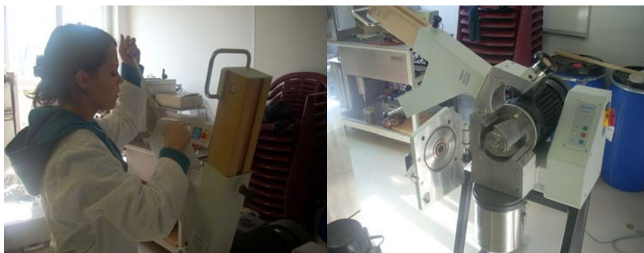
Slika 3: Dodajanje vzorca v mlin (levo) in mlin Retsch SM 2000 (desno)
