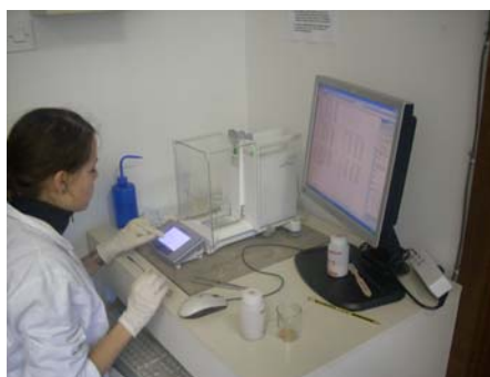
Slika 5: Laboratorijska tehtnica Mettler Toledo XS, ki smo jo uporabili za gravimetrično analizo vzorcev
