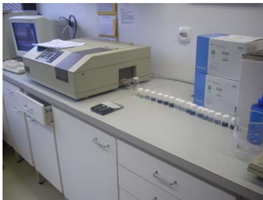
Slika 12: UV-Vis spektrofotometer in sveže pripravljene raztopine reagentov in lesnega ekstrakta, sveže pripravljene zmesi standardnih raztopin galne kisline in reagentov ter slepi vzorec
