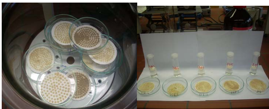
Slika 8: Prikaz suhega ostanka po filtraciji v eksikatorju (levo) ter ekstrakt in vzorec po ekstrakciji (desno)
