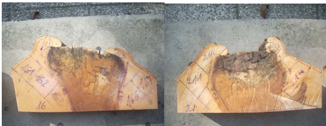
Slika 25: Navadna bukev ( Fagus sylvatica L.) – prečni prerez, drevo št. 2, kolut 16 (levo) in kolut 21 (desno)
