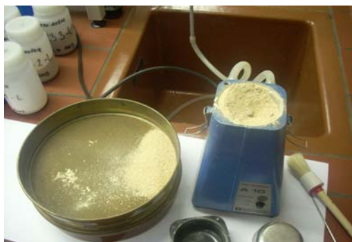
Slika 4: Laboratorijski mlinček in frakcija, ki je ostala na situ mreže 0,4 mm
