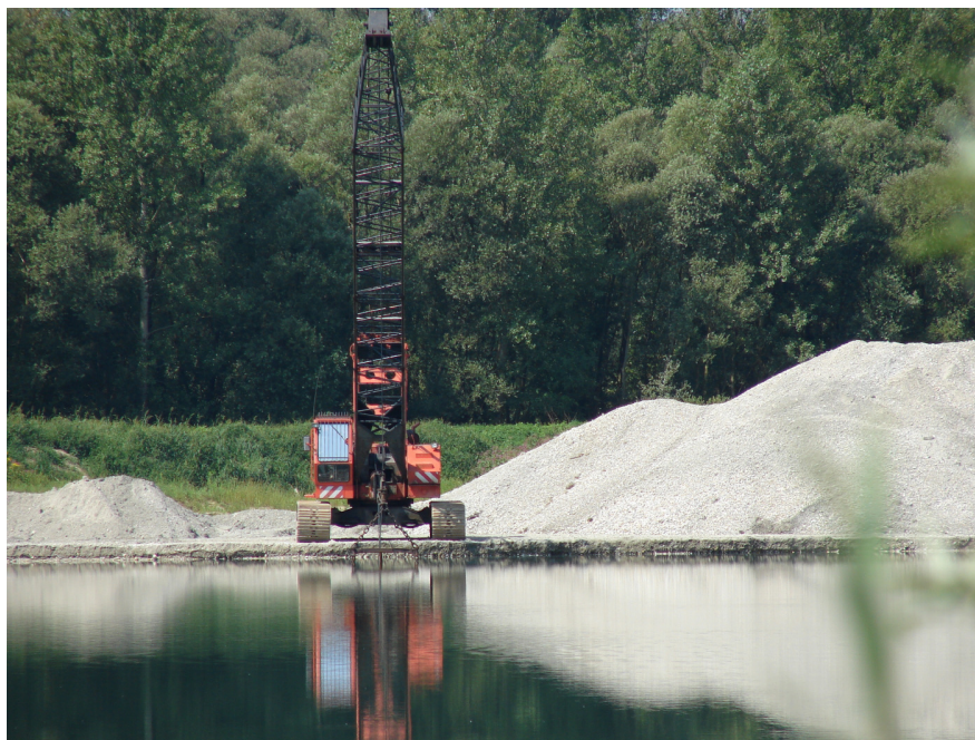
Slika 2: Aktivno izkopavanje gramoza, ki ga v Petišovcih izvaja podjetje Gramoz (SGP Gradbenik). Na sliki lahko poleg vodne površine vidimo tudi nasutine prod in peska, ki so prav tako sestavni deli gramoznice.
