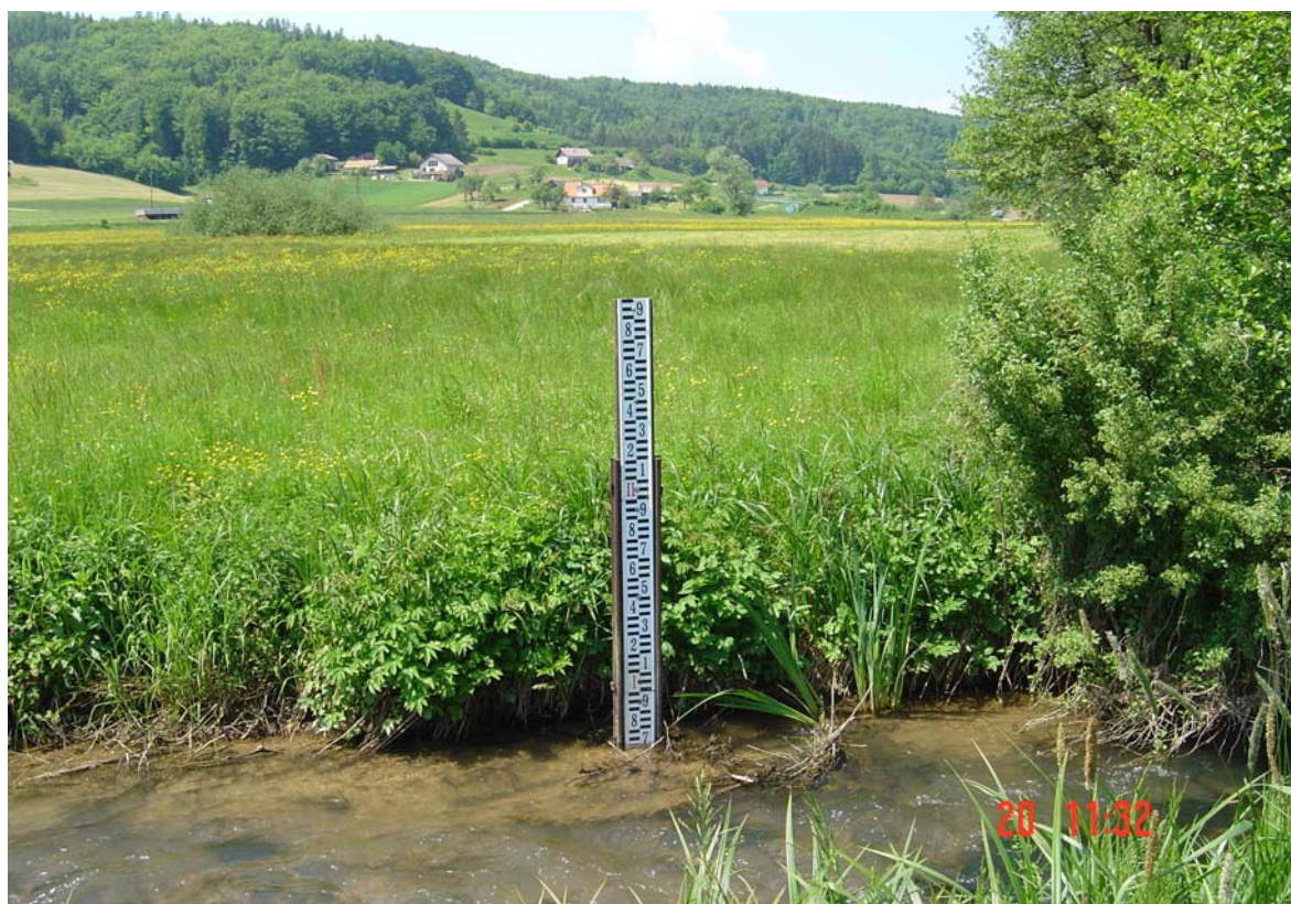
Slika 24: Merilna lata za merjenje vodostaja (Trebnje, 20.5.2004).
