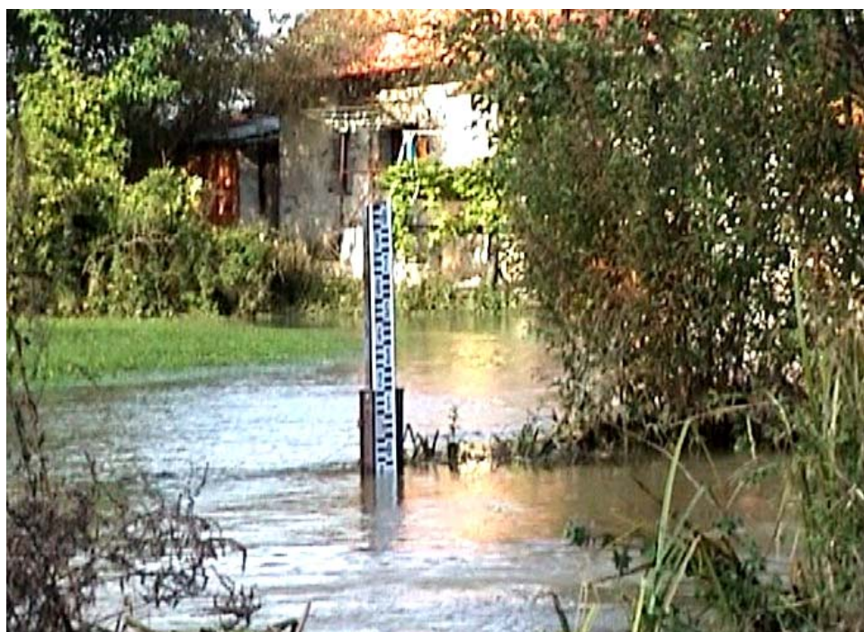
Slika 25: Merilna lata za merjenje vodostaja (Trebnje, 18.10.2004).
