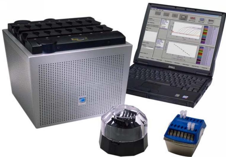
**Slika 4:** SmartCycler aparat z računalnikom, hladnim blokom in reakcijskim tubicami ter centrifugo (Cepheid, 2012).
