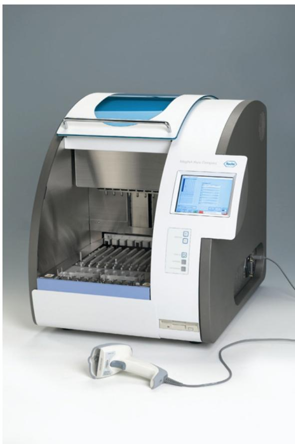
**Slika 3:** Aparatura MagNa Pure Compact za avtomatsko izolacijo glivne DNK proizvajalca Roche (Roche, 2012).
