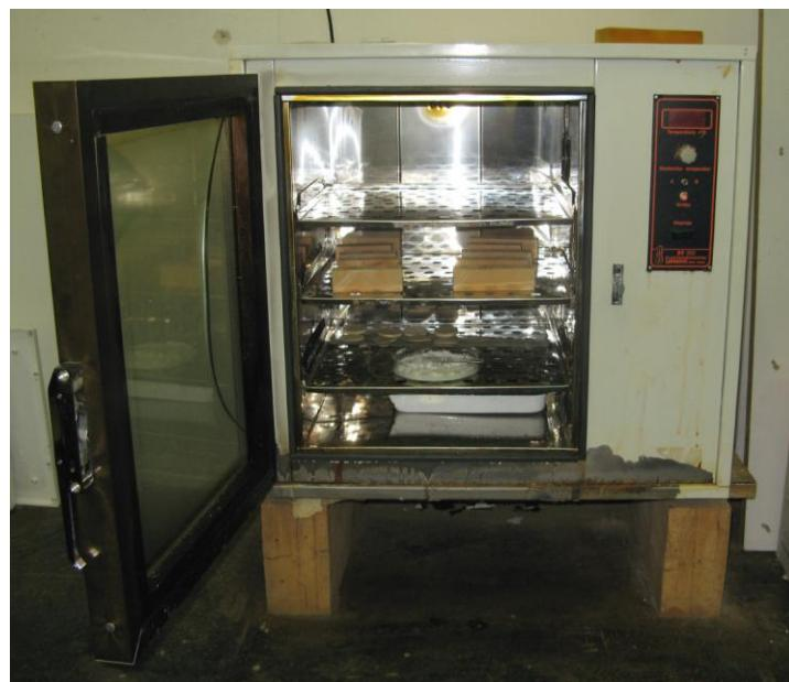
**Slika 3.1:** Sušilnik, kjer smo sušili manjše vzorce (Laboratorij za sušenje lesa, Oddelek za lesarstvo)
