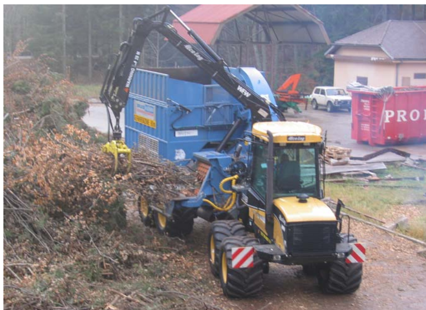
Slika 3: Stroj za sekanje pri sekanju sečnih ostankov (foto: L. Biščak)
