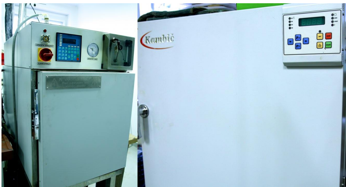
Slika 16: Vakuumski (levo) in laboratorijski sušilnik (desno)
