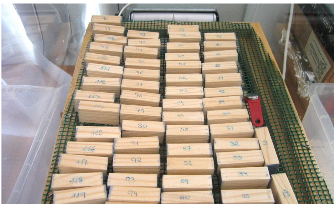
Slika 18: Navlaževanje vzorcev v klima komori
