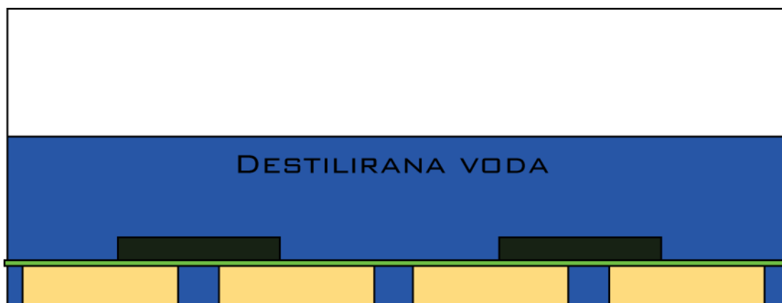
Slika 17: Shematski prikaz namakanja vzorcev v destilirani vodi
