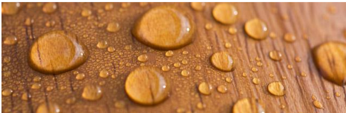
Slika 10: Vodo-odbojnost lesne površine, dosežena z obdelavo z voskom (Momentive wax..., 2012)
