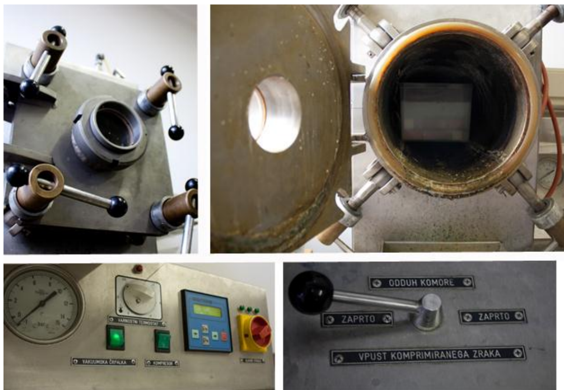
Slika 13: Vakuumsko - tlačna komora Kambič, za impregnacijo lesnih vzorcev
