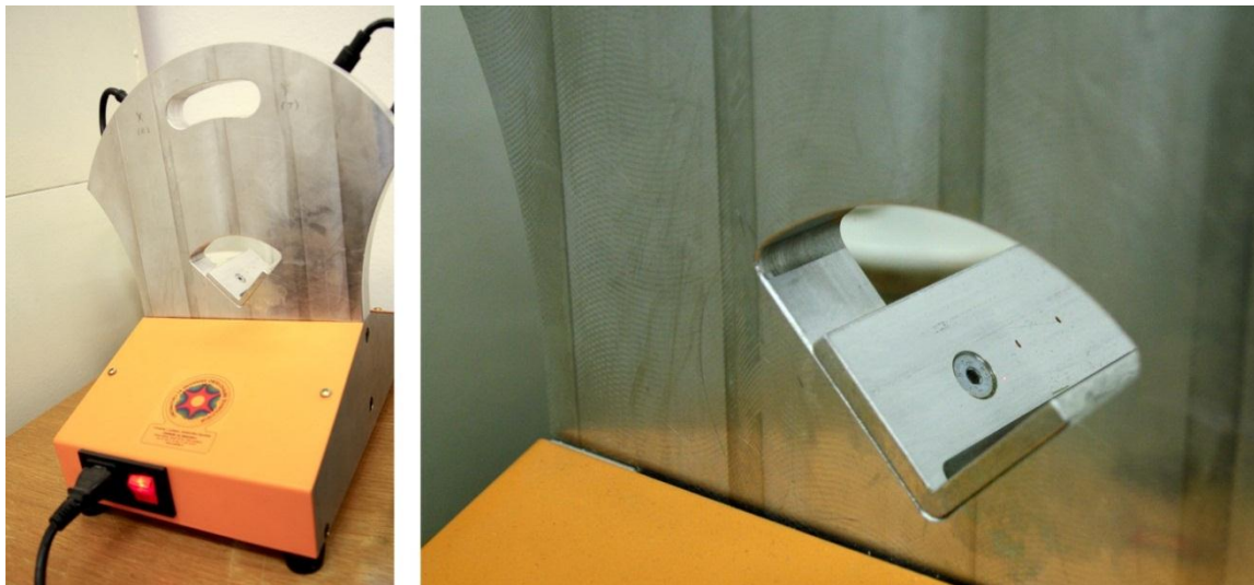
Slika 20: Laserski merilnik dimenzij (Biotehniška fakulteta, Oddelek za lesarstvo, Katedra za Mehanske obdelovalne tehnologije)
