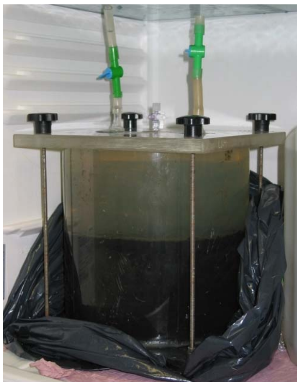
Slika 14: Simulacijski poskus v laboratoriju – bentoška posoda z odvzetim sedimentom iz Gradeške lagune
