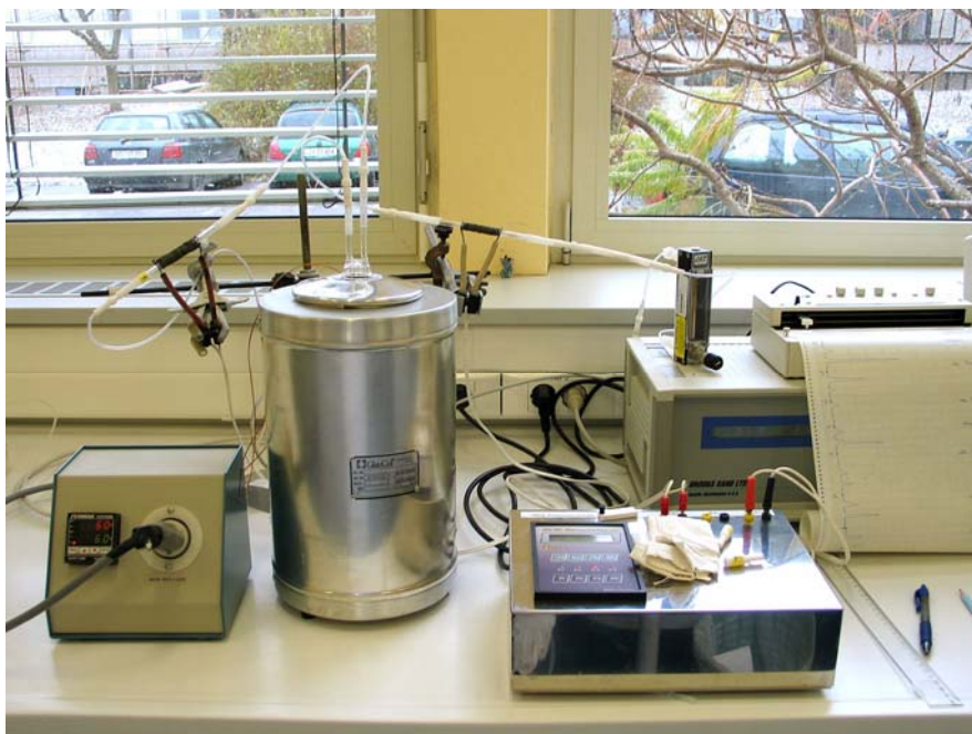
Slika 17: Elucija s pasti, separacija s plinsko kromatografijo in detekcija MeHg s CV – AFS
