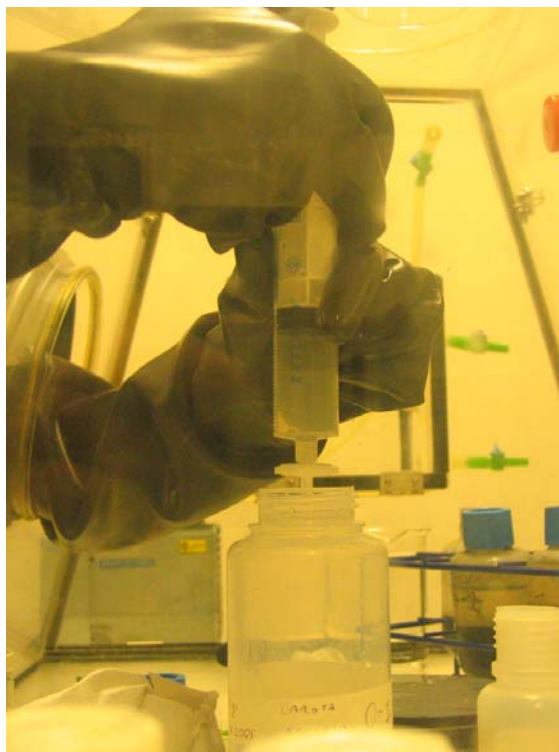
Slika 15: Filtracija vzorca pornih vod v anaerobni komori v Laboratoriju za morsko biologijo v Nabrežini pri Trstu
