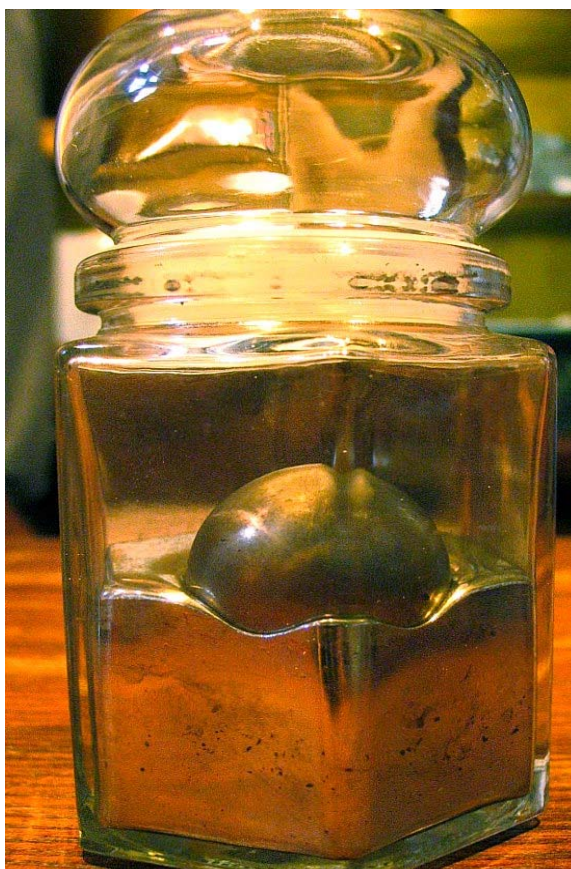
Slika 2: Železna krogla plava na elementnem Hg. To dokazuje, da ima živo srebro večjo specifično težo in je gostejše od železa. Antonijev rov (muzejska zbirka), Idrija
