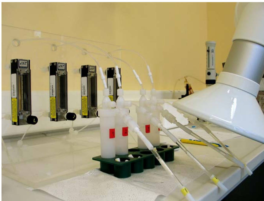
Slika 16: Prepihovanje etilacijske mešanice z N_2 (angl. bubbling), pri čemer se etilirani MeHg ujame na pasti iz Tenax-a
