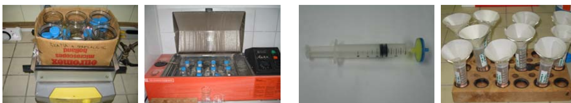
Slika 9: Slikovni prikaz postopkov stresanja, centrifugiranja in filtriranja.
