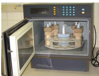
Slika 12: Mikrovalovna pečica s teflonskimi lončki na vrtljivem pladnju
