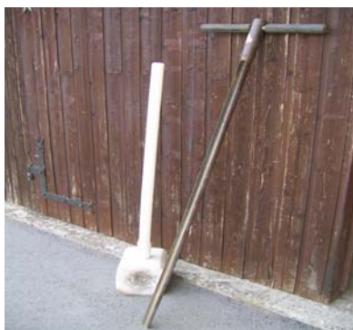
Slika 7: Koničasta sonda za odvzem talnih vzorcev
