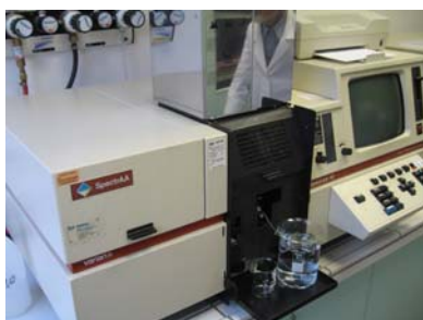
Slika 23: Plamenski atomski absorpcijski spektrometer, ki smo ga uporabili pri naših meritvah
