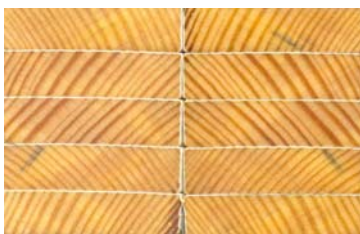
Slika 8: Obarvanje s premazom 9 premazanih nemodificiranih vzorcev po preseku
