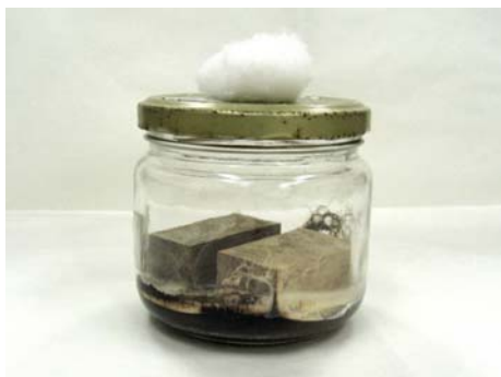
Slika 13: Modificiran in nemodificiran vzorec, izpostavljen delovanju kletne gobe
