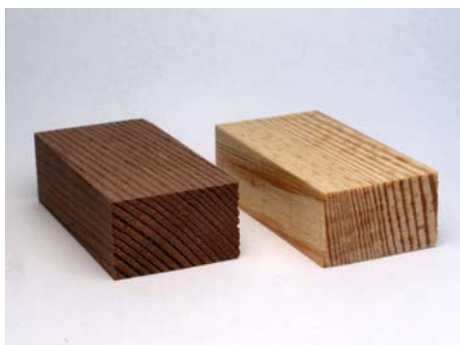
Slika 18: Modificiran in nemodificiran kontrolni vzorec po izpostavitvi hranilnemu gojišču
