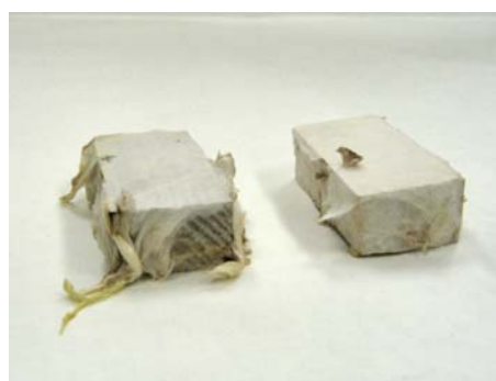
Slika 11: Modificiran in nemodificiran vzorec, izpostavljen delovanju sive hišne gobe
