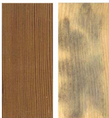
Slika 1: Izgled nepremazanih kontrolnih modificiranih in nemodificiranih vzorcev po izpostavitvi glivam modrivkam
