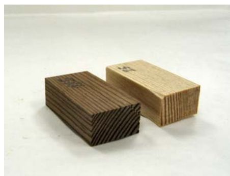
Slika 17: Modificiran in nemodificiran kontrolni vzorec, izpostavljen hranilnemu gojišču
