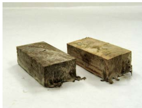
Slika 13: Modificiran in nemodificiran vzorec, izpostavljen delovanju kletne gobe
