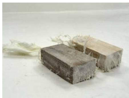
Slika 9: Modificiran in nemodificiran vzorec, izpostavljen delovanju bele hišne gobe
