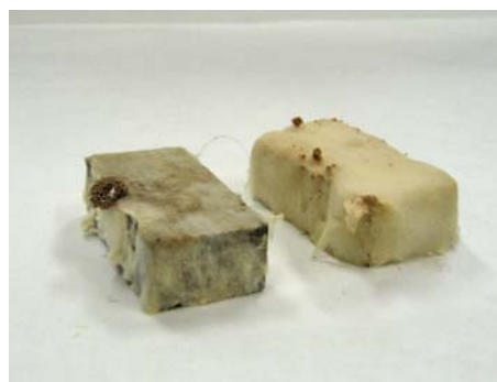
Slika 15: Modificiran in nemodificiran vzorec, izpostavljen delovanju navadne tramovke
