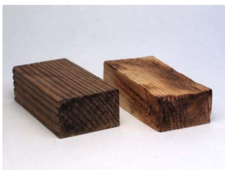
Slika 14: Modificiran in nemodificiran vzorec po izpostavitvi kletni gobi
