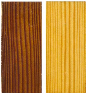
Slika 5: Izgled s premazom 8 premazanih modificiranih in nemodificiranih vzorcev po izpostavitvi glivam modrivkam
