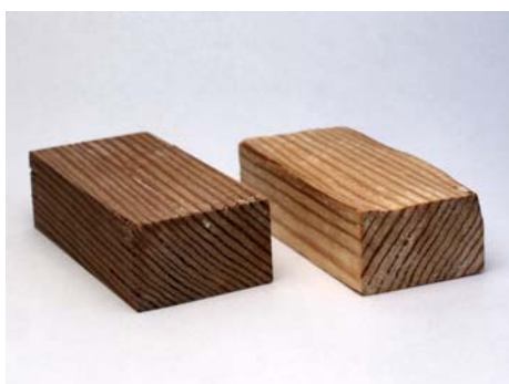
Slika 10: Modificiran in nemodificiran vzorec po izpostavitvi beli hišni gobi
