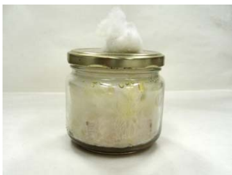
Slika 11: Modificiran in nemodificiran vzorec, izpostavljen delovanju sive hišne gobe
