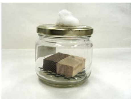
Slika 17: Modificiran in nemodificiran kontrolni vzorec, izpostavljen hranilnemu gojišču
