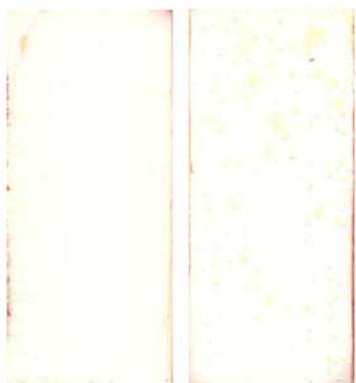
Slika 4: Izgled s premazom 5 premazanih modificiranih in nemodificiranih vzorcev po izpostavitvi glivam modrivkam
