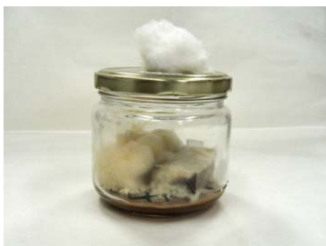
Slika 15: Modificiran in nemodificiran vzorec, izpostavljen delovanju navadne tramovke
