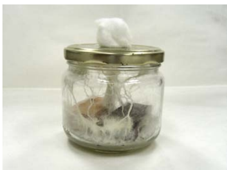
Slika 9: Modificiran in nemodificiran vzorec, izpostavljen delovanju bele hišne gobe
