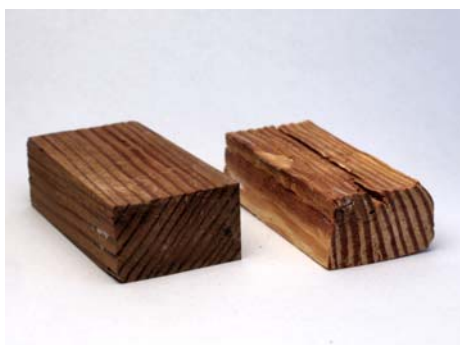
Slika 16: Modificiran in nemodificiran vzorec po izpostavitvi navadni tramovki
