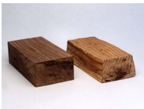
Slika 12: Modificiran in nemodificiran vzorec po izpostavitvi sivi hišni gobi
