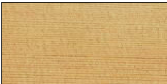
Slika 2: Makroskopski izgled resonančne smrekovine v radialnem prerezu (Coombe, 2007)
