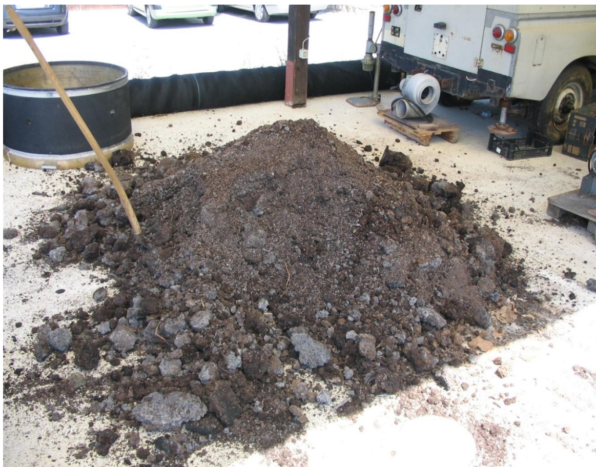
Slika 3: Mešanje kompostne mešanice iz bioreaktorja
