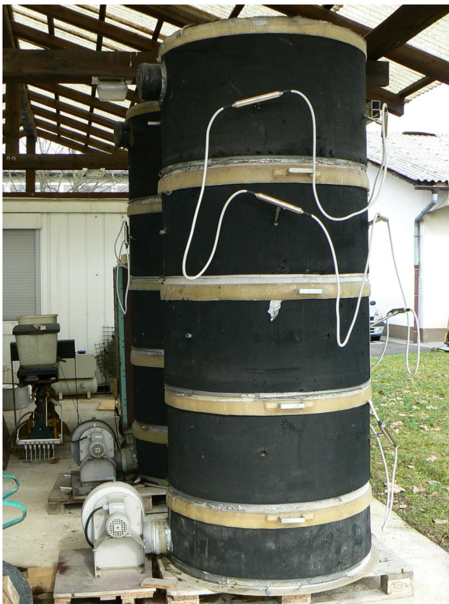
Slika 2: Biorektorja za poskus kompostiranja oljčnih tropin
