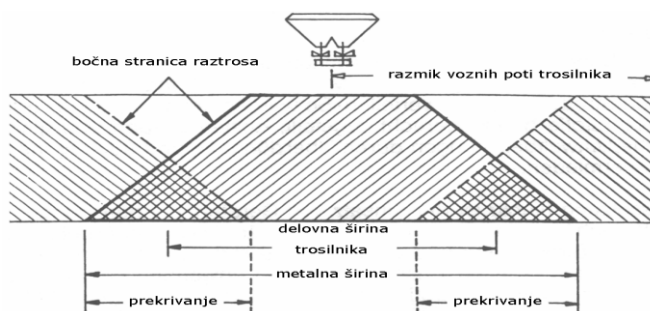
Slika 6: Prikaz razlike med delovno širino in metalno širino trosilnika (Bernik, 2005)
