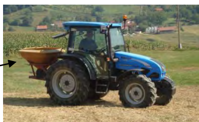
Slika 11: Traktor Landini 75S s trosilnikom mineralnih gnojil Vicon Creina PS 502 (Foto: Jekovec, 2011)
