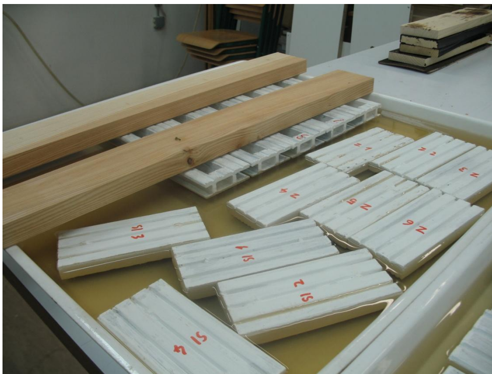
Slika 13: Namakanje vzorcev v destilirani vodi po metodi SIST EN 927-5 Vzorce lesnega kompozita smo pritrdili na desko, da se niso potopili.
