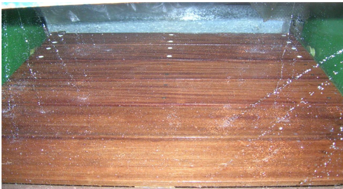
Slika 16: Vzorec »terase« med polivanjem z destilirano vodo v napravi za umetno pospešeno staranje
