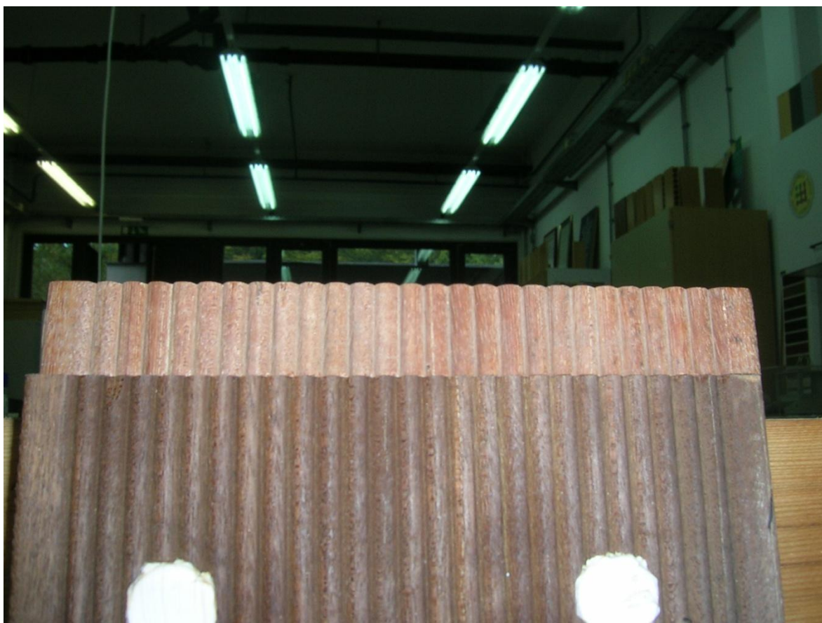
Slika 25: Razlika med testiranim vzorcem (spredaj) in vzorcem, ki ni bil podvržen umetnemu pospešenemu staranju
