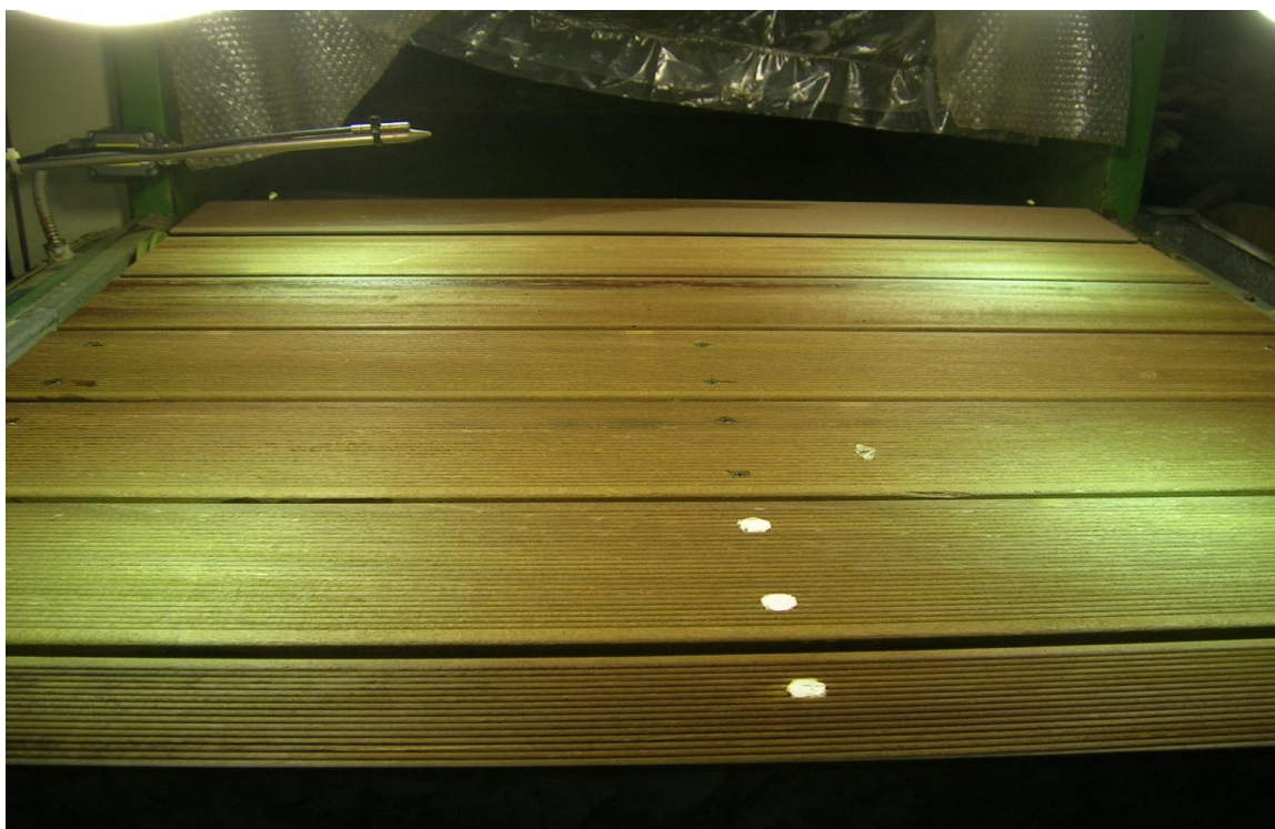
Slika 17: Vzorec »terase« med obsevanjem z UV svetlobo v napravi za umetno pospešeno staranje
