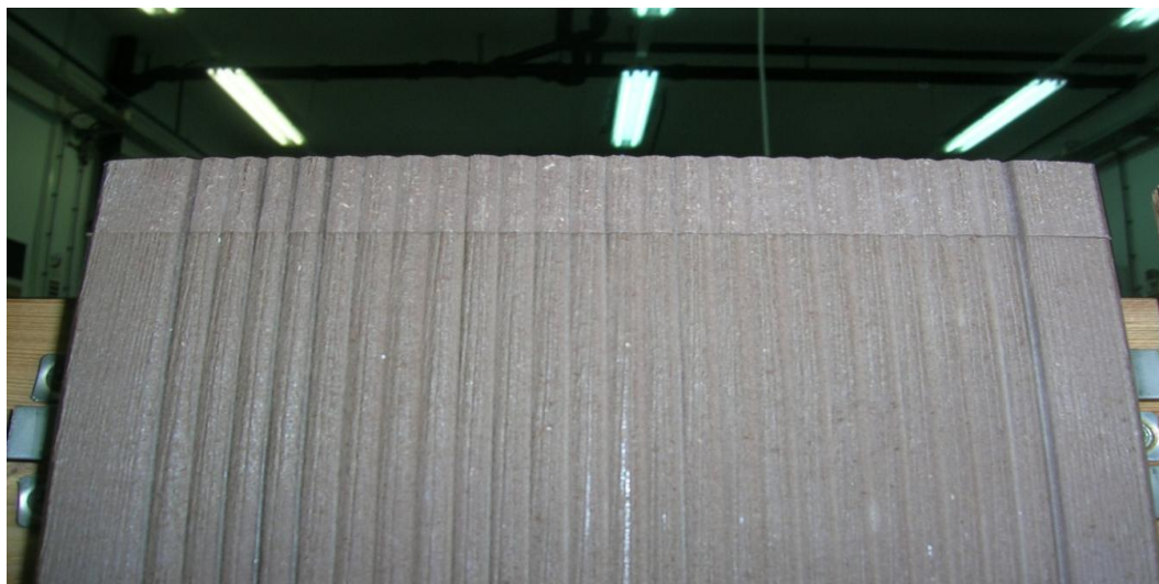
Slika 31: Barvna razlika med koščkom, ki smo ga skladiščili (zgoraj), in testiranim vzorcem lesnega kompozita (spodaj)
