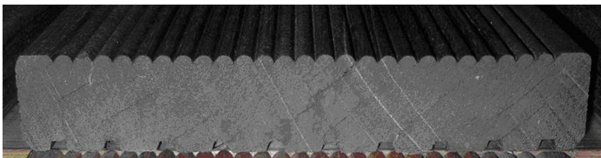
Slika 29: Čelne razpoke v lesu bangkaira po izpostavitvi umetnemu pospešenemu staranju
