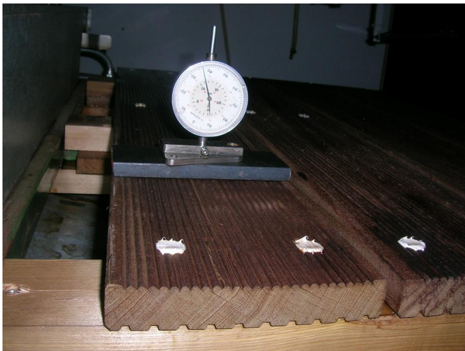
Slika 19: Merjenje koritavosti desk z merilno urico med postopkom umetnega pospešenega staranja
