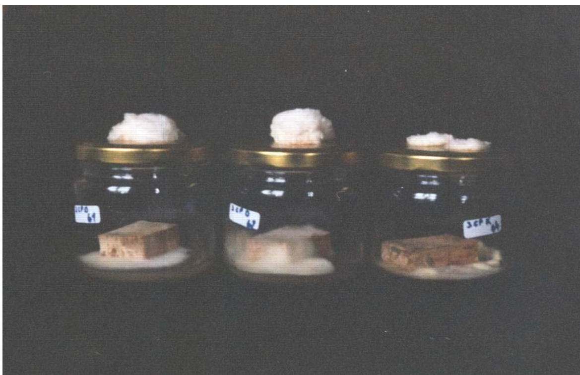
Slika 22: Vzorci lesa okuženi z glivo Coniophora puteana dušeni z dušikom; v tretjem kozarcu je kontrolni vzorec (Foto: M. Jenišek)
