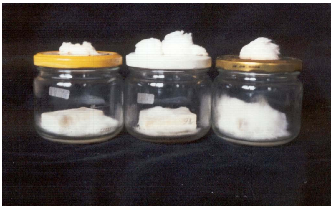
Slika 19: Vzorci lesa okuženi z glivo Antrodia vaillantii dušeni z argonom; v tretjem kozarcu je kontrolni vzorec (Foto: M. Jenišek)
