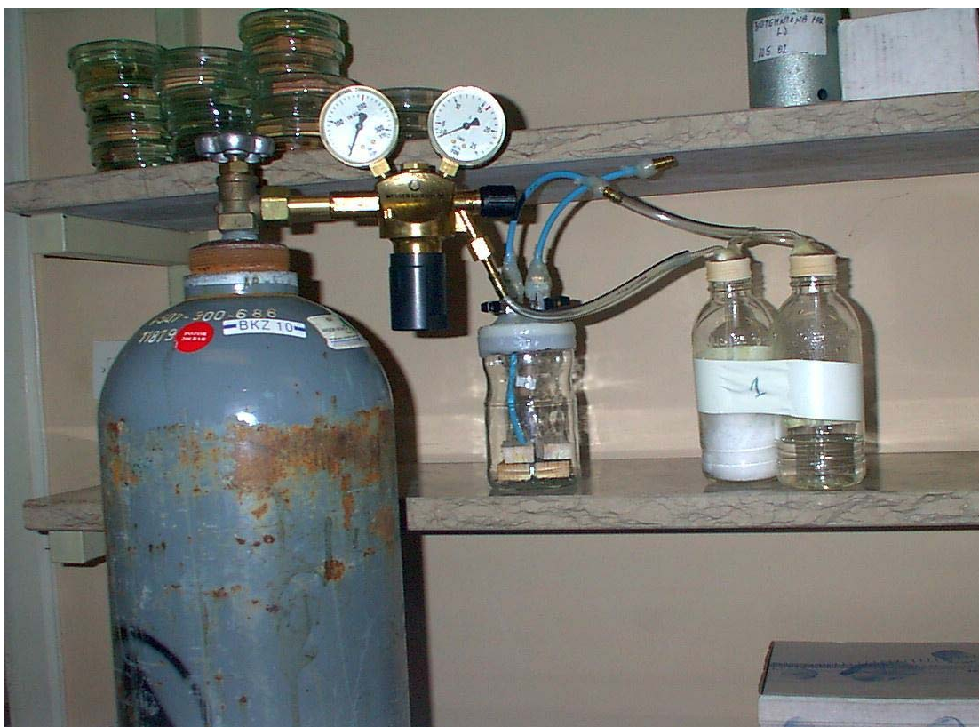
Slika 12: Dušenje okuženih vzorcev lesa v steklenen kozarcu z inertnim plinom (Foto: M. Jenišek)
