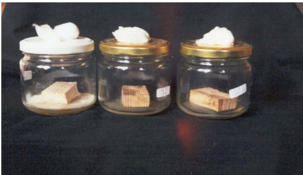
Slika 21: Vzorci lesa okuženi z glivo Coniophora puteana dušeni z argonom; v prvem kozarcu je kontrolni vzorec (Foto: M. Jenišek)
