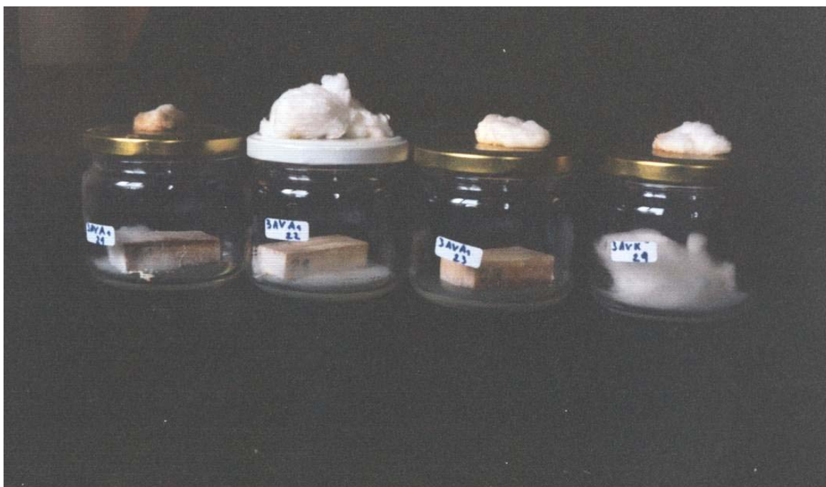
Slika 16: Vzorci lesa okuženi z glivo Antrodia vaillantii dušeni z argonom; v četrtem kozarcu je kontrolni vzorec (Foto: M. Jenišek)
