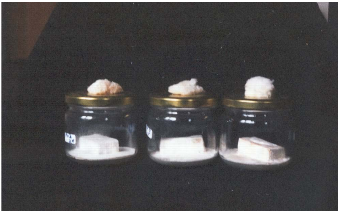
Slika 17: Vzorci lesa okuženi z glivo Trametes versicolor ; v prvem kozarcu dušeni z argonom, v drugem z dušikom, v tretjem kozarcu je kontrolni vzorec (Foto: M. Jenišek)
