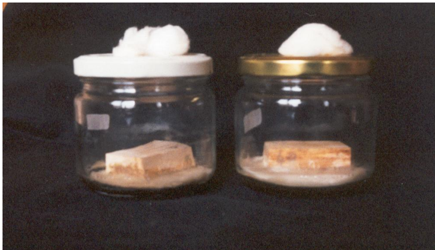
Slika 9: Kozarec z vzorcem lesa in razraščnim micelijem (Foto: M. Jenišek)
