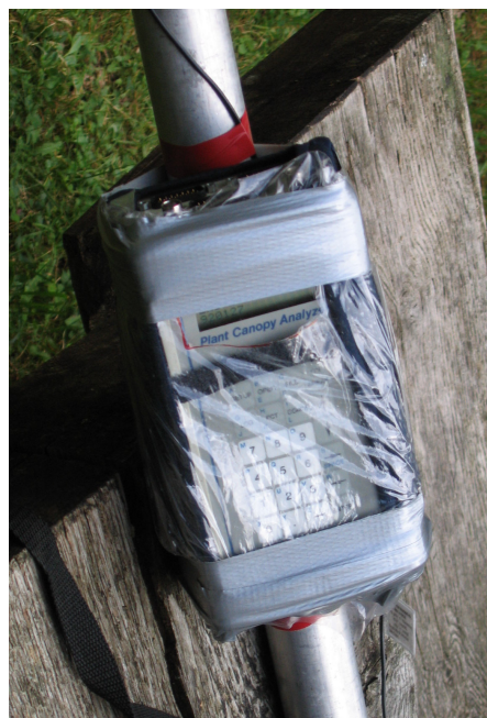
Slika 4: LI-COR kvantni senzor 190SA (levo), pritrjen na vrhu merilne palice, in LAI-2000 Plant canopy analyzer (desno), pod njim je pritrjen sprožilec (ni na sliki) (foto: Jenko, 2005)
