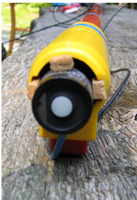
Slika 4: LI-COR kvantni senzor 190SA (levo), pritrjen na vrhu merilne palice, in LAI-2000 Plant canopy analyzer (desno), pod njim je pritrjen sprožilec (ni na sliki) (foto: Jenko, 2005)
