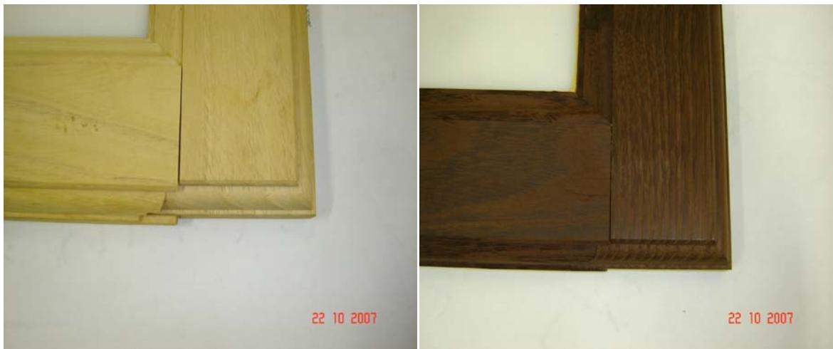
Slika 15 Razlika v nabrekanju na spoju med nemodificiranim (A02) in modificiranim (A6) preizkušancem pri robiniji.
