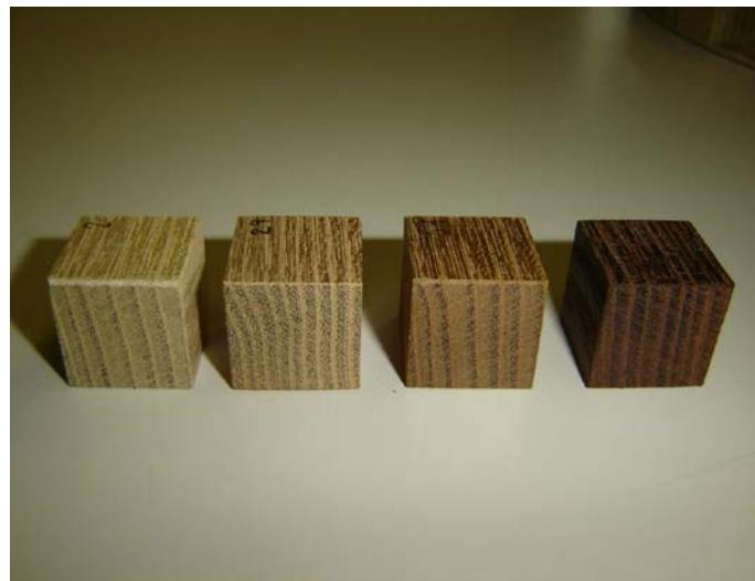
Slika 1 Kontrolni vzorec in vzorci modificirani pri temperaturah 150 °C, 175 °C in 200 °C. Dobro viden je vpliv temperature modifikacije na barvo lesa.
