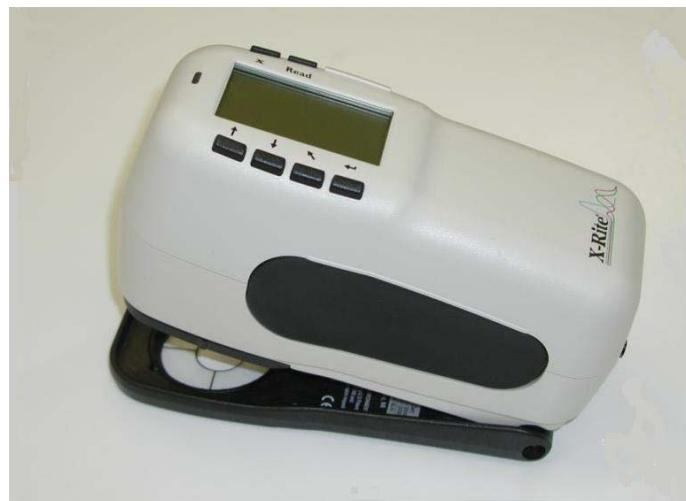
Slika 11 Spektrofotometer X-Rite SP 62.
