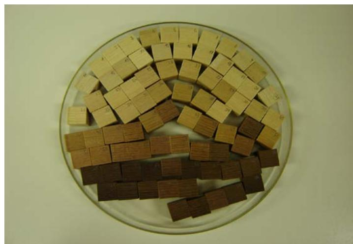
Slika 5 Robinijski vzorci pripravljeni za testiranje dimenzijske stabilnosti.
