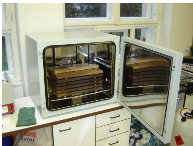
Slika 6 Laboratorijski sušilnik podjetja Kambič.
