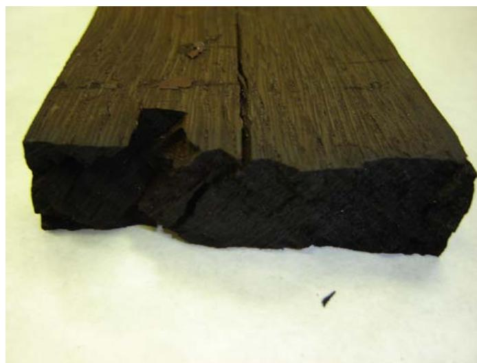
Slika 3 Popolna termična degradacija hrastovega vzorca pri temperaturi modifikacije 240 °C.
