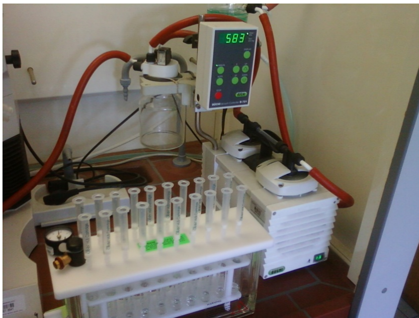
Slika 3: Prikaz kolektorja za ekstrakcijo na trdni fazi, kartuš za ekstrakcijo in vakuumske črpalke.
