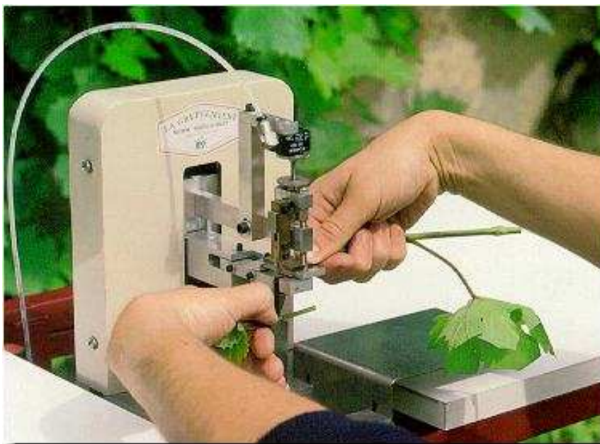
Slika 3: Prikaz strojnega cepljenja zeleno na zeleno (Gregorič J.).
