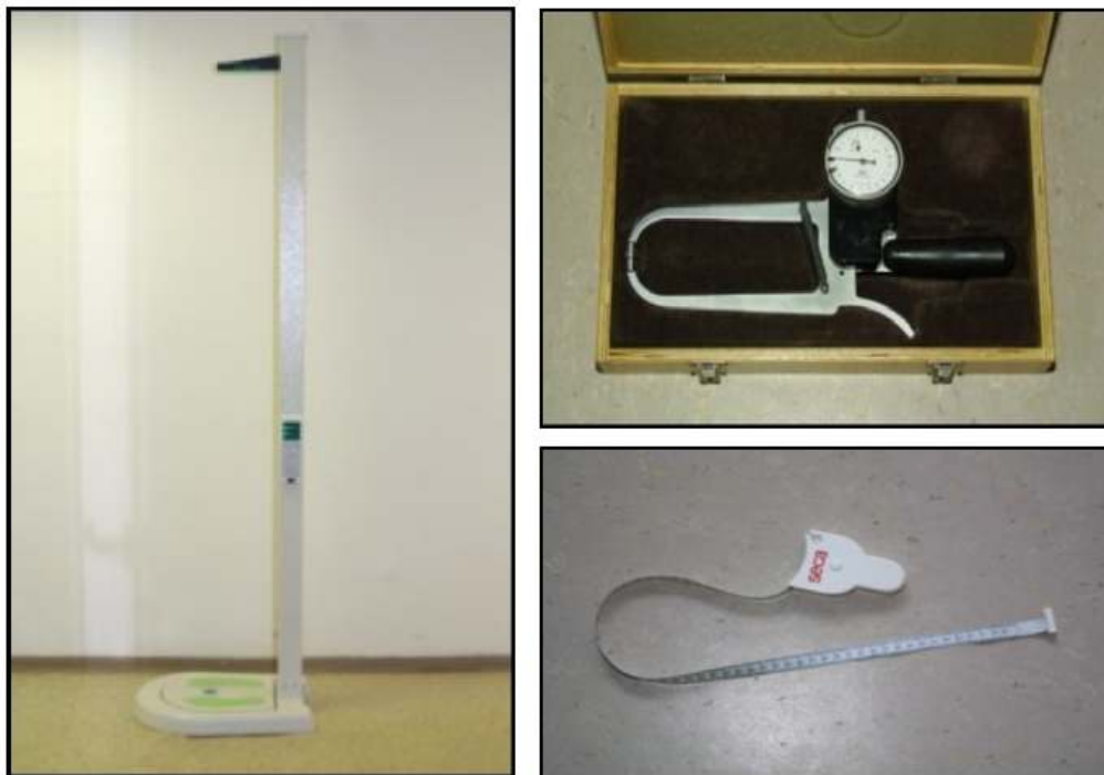
Slika 3.2: Antropometrijski merilni inštrumenti: levo – osebna tehtnica z vgrajenim avtomatskim antropometrom VITA DS-102, desno zgoraj – kaliper Harpenden (John Bull), desno spodaj – merilni trak SECA 200.
