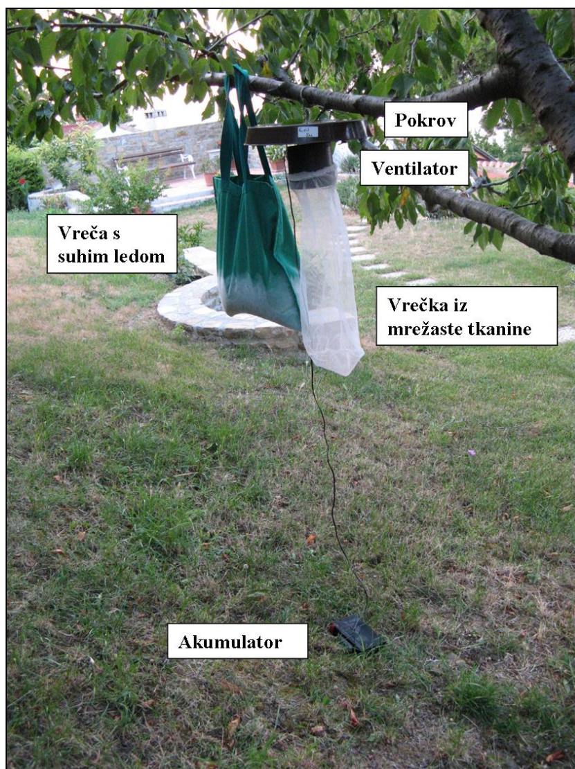
Slika 9: Postavitev pasti na vzorčnem mestu v Fiesi. Na sliki so označeni sestavni deli pasti (Foto: Katja Kalan).
