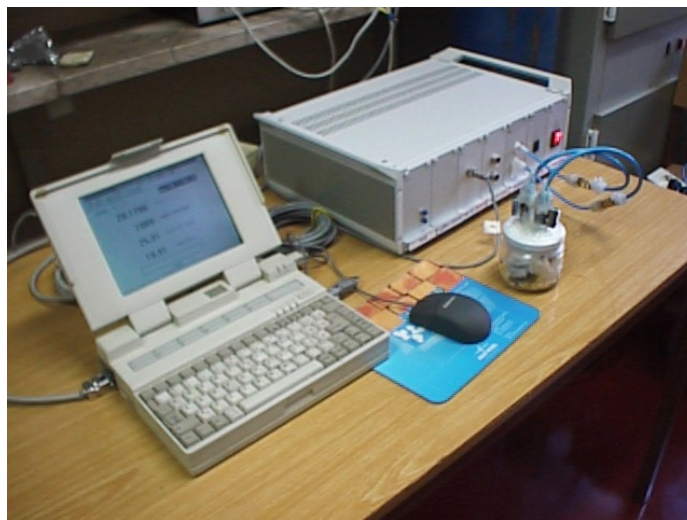
Slika 4: Celoten sistem za merjenje respiracije (računalnik, zračna črpalka in eksperimentalni kozarec)
