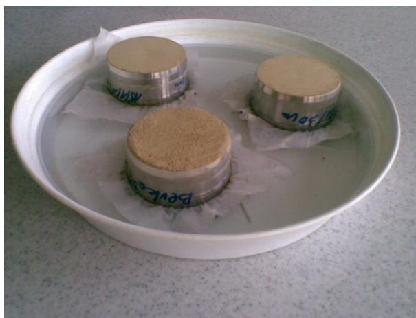
Slika 5: Vlaženje vzorcev. Na spodnji strani cilindra je nameščena gaza in pod gazo podstavek z luknjami. Tako pripravljene cilindre so nameščene v večjo posodo (višina cca. 7 cm) z vodo, ki sega do 1 cm pod robom cilindra
