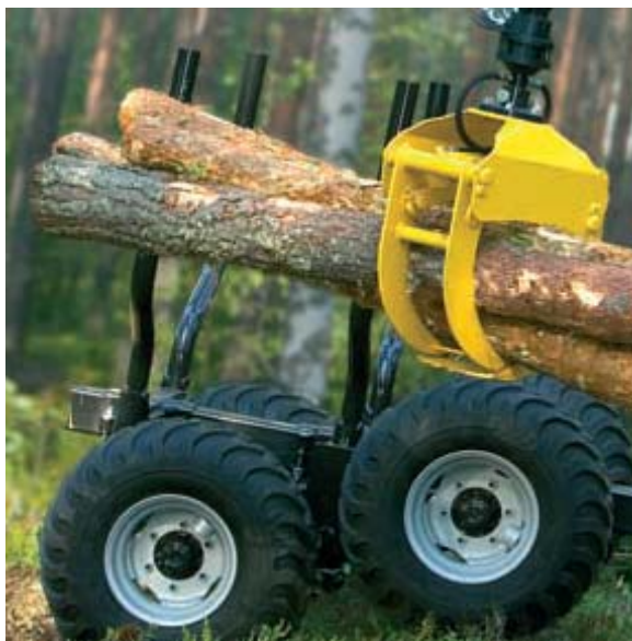
Slika 7: Gibljivo tandemsko podvozje za lažje premaganje ovir (vir: Kesla, 2011)
