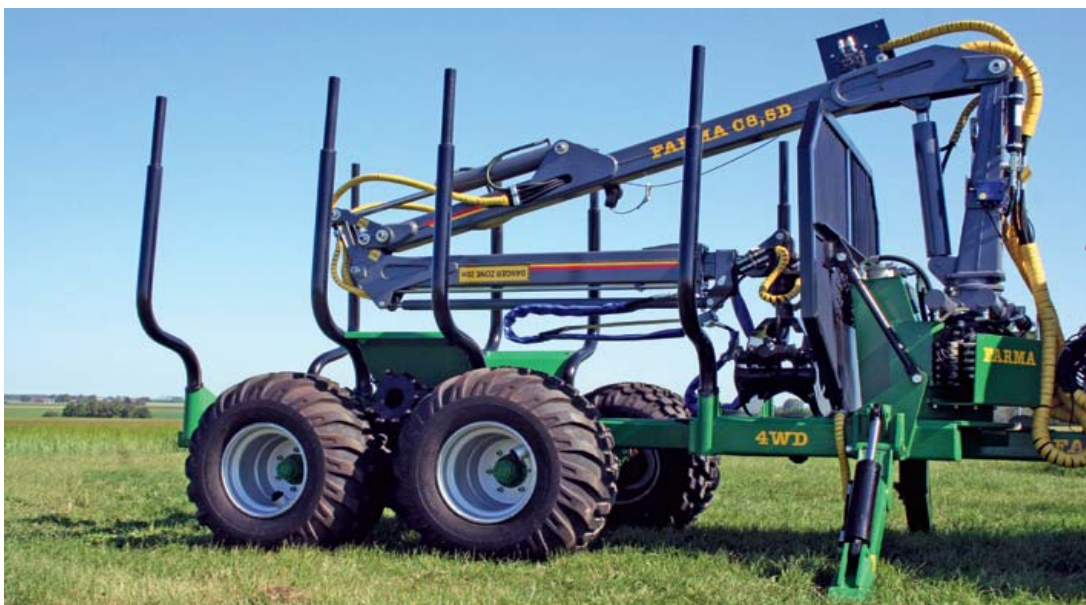
Slika 4: 14-tonska gozdarska prikolica Farma s pogonom (vir: Farma, 2012)
