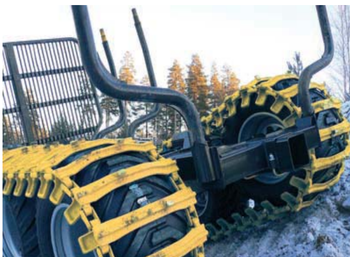
Slika 6: Montaža gosenic za boljši oprijem na spolzkih terenih, prikolica mora imeti pogon (vir: Kesla, 2011)
